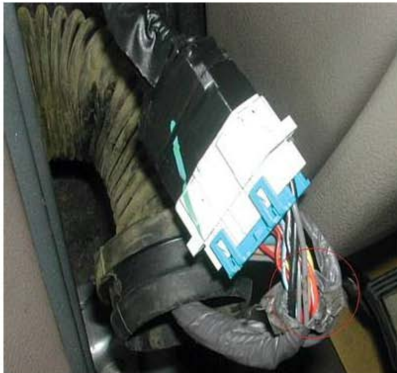
图 2 左前门门锁线束破损
