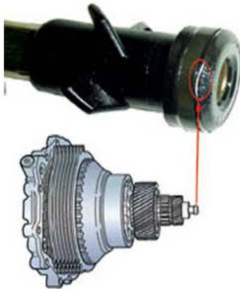
图 3 前进离合器进油管头部有凹痕
