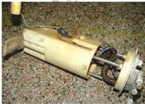
图 2 燃油泵过度磨损
