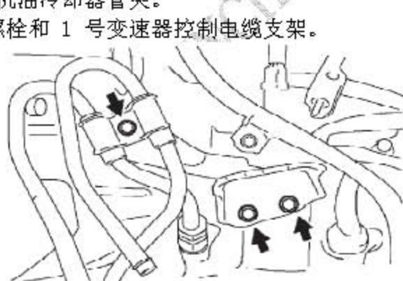
68). 拆卸变速器油加注管分总成
