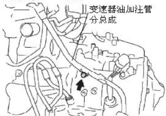
69). 拆卸 1 号机油冷却器进口管
