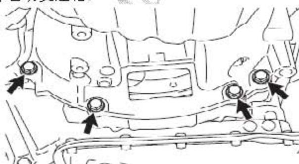
61). 拆卸变矩器离合器总成
