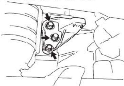
3). 安装变速器油加注管分总成
