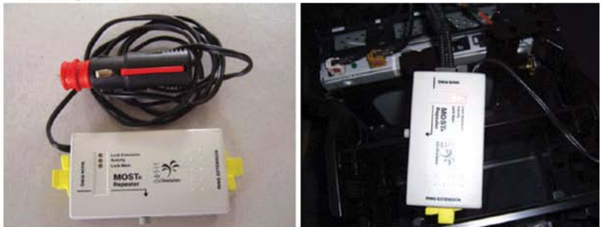
图 6 光学替换控制单元 VAS 6186
