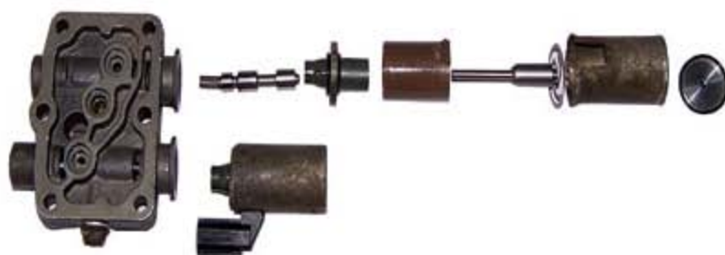
图 1 滑阀顶部锈蚀
