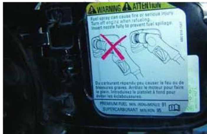
图 4 油箱加注口处有关加油方法的提示
