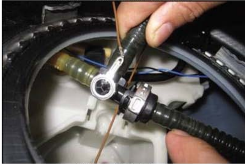
漏油的三通管接头
