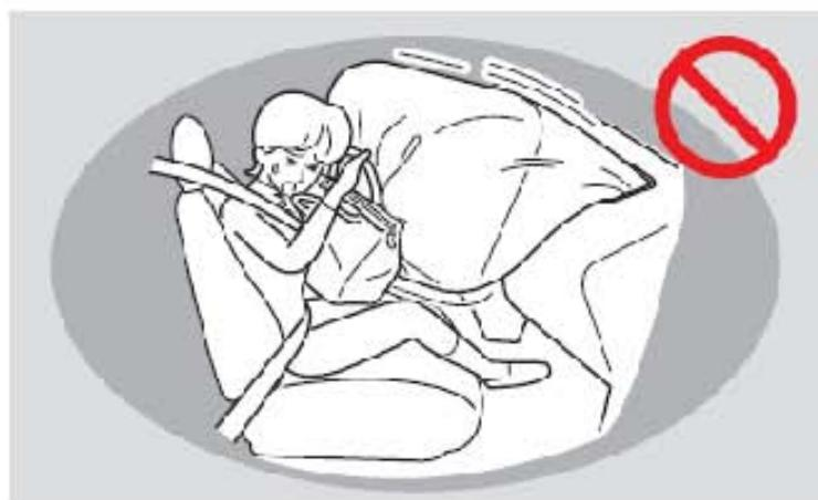
将任何物品放在驾驶员/前座乘客与方向盘/仪表板之间，都有可能导致在车受到猛烈的前撞击时，由于安全气囊不能正常工作而带来的严重身体伤害。
