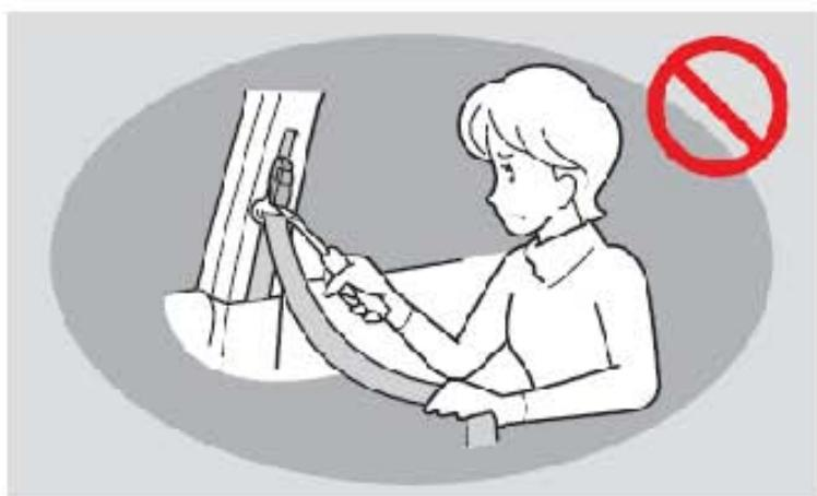
禁止用户改动或附加安全带，这样安全带对使用者的保护将大大下降。如安全带开裂、污染或损坏应立即更换。
