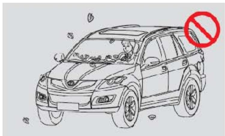
3). 前风挡玻璃下缘的进气口堆有积雪、落叶时，应及时清除。
