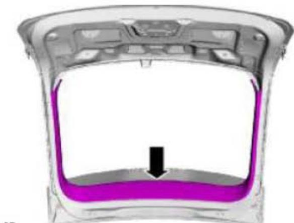
5) . 拆开尾门上的后扰流板。
