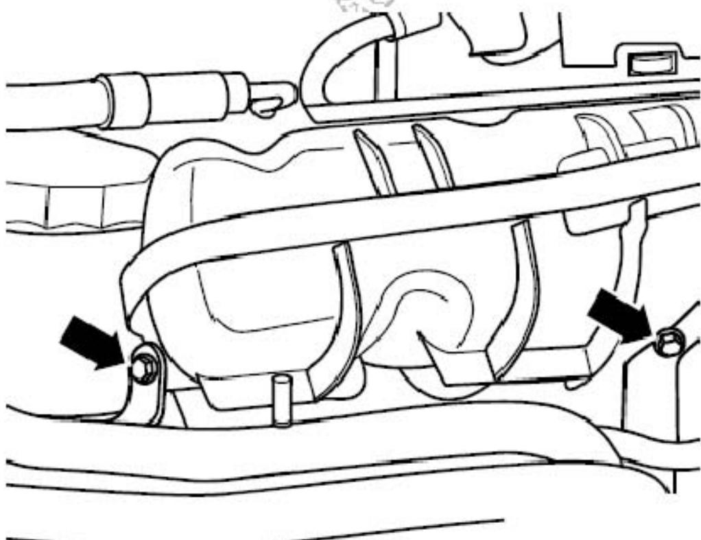
14). 脱开进气管上的导线（下图箭头所示）。
