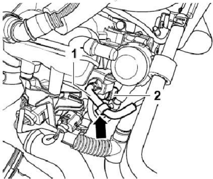
12). 用拆卸工具将连接插头从燃油压力传感器 - G247- 上拔下。
