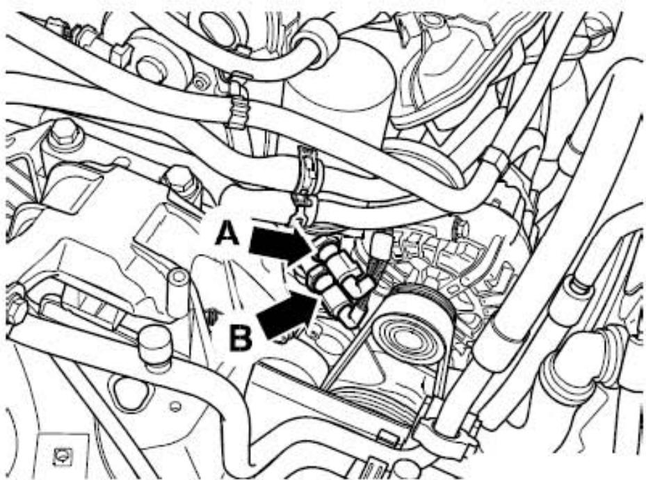
17). 旋出螺母(下图 1 所示), 用十二角花键旋出螺栓(下图 2 所示)。取下进气管支架。
