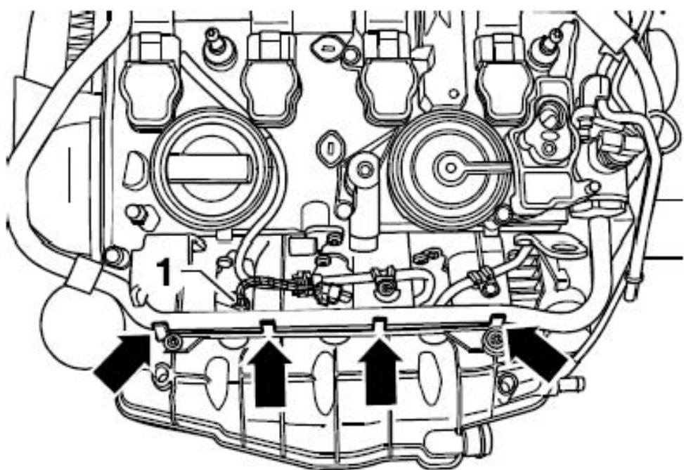
9). 脱开卡子(下图箭头所示), 松开弹簧卡箍(下图 1 所示), 并将真空软管放置一旁。
