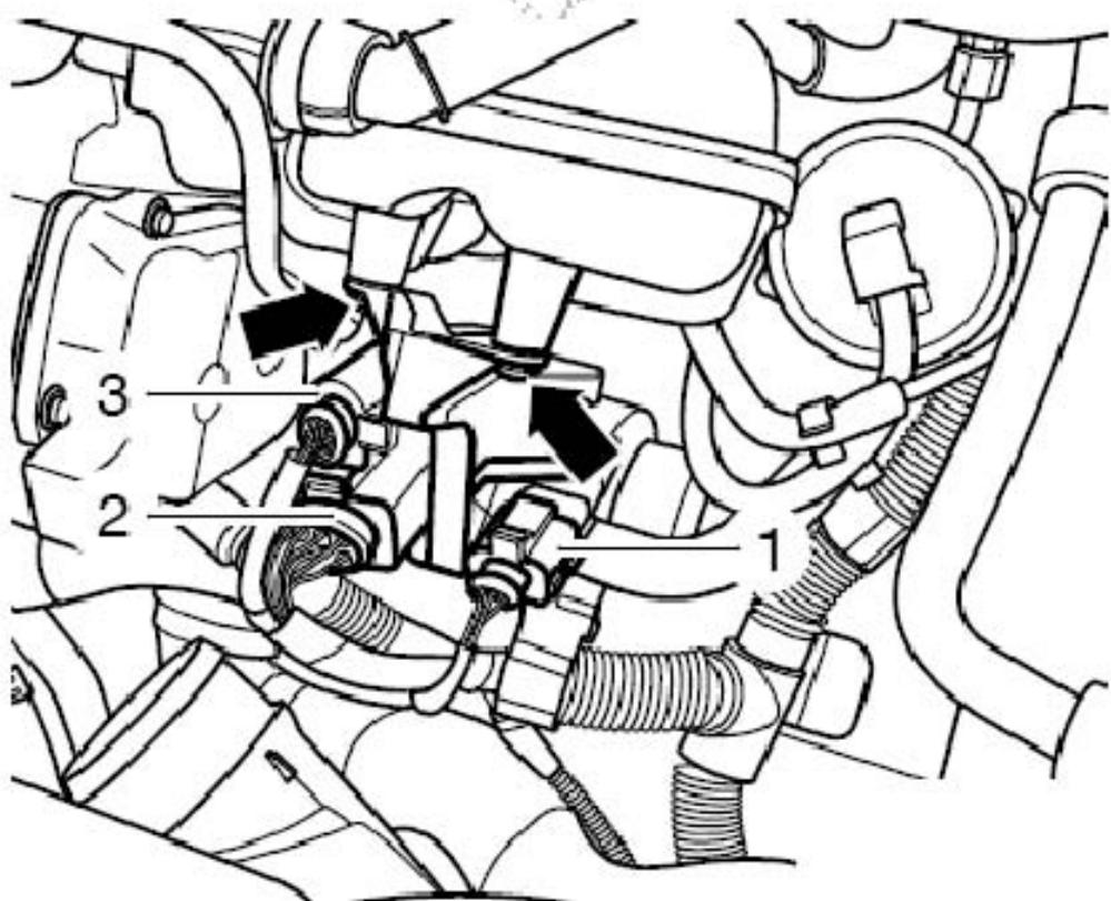
16). 拔下机油压力开关 - F22- 的插头(下图箭头 A 所示)。拔下机油压力开关 - F1- 的插头(下图箭头 B 所示)用机油滤清器扳手拆下机油滤清器。
