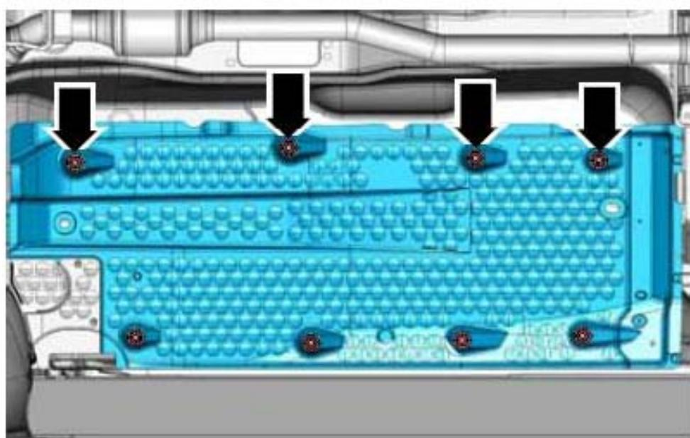
2). 脱开卡子（下图箭头所示），断开插头连接（下图 1 所示）使导线与支架分离。
