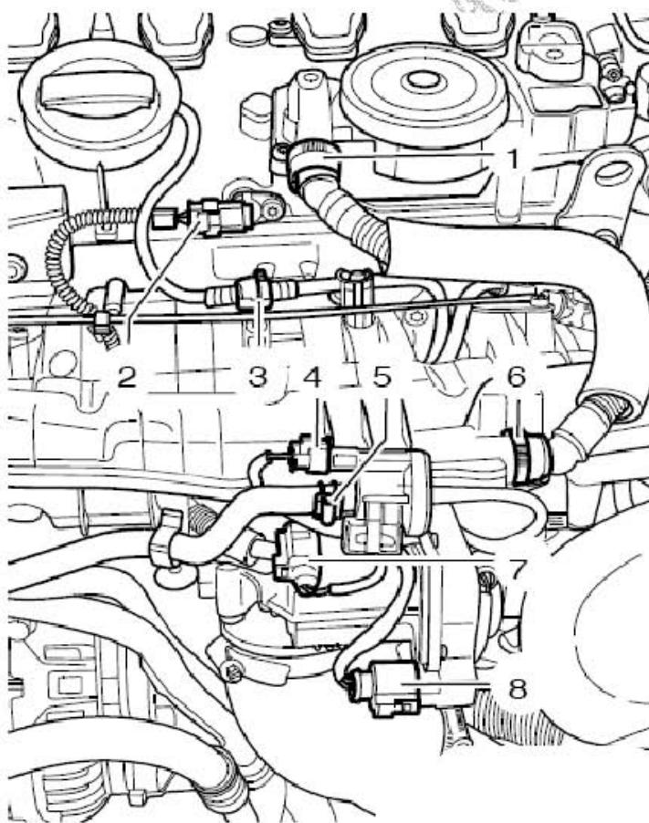
8). 脱开卡子(下图箭头所示), 将燃油供油管放置一旁。脱开卡子(下图 1 所示), 将霍尔传感器 - G40- 的线束放置一旁。
