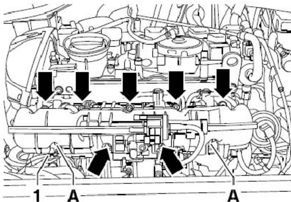
20). 拔下进气管风门电位计 - G336- 的插头（下图箭头所示）。
