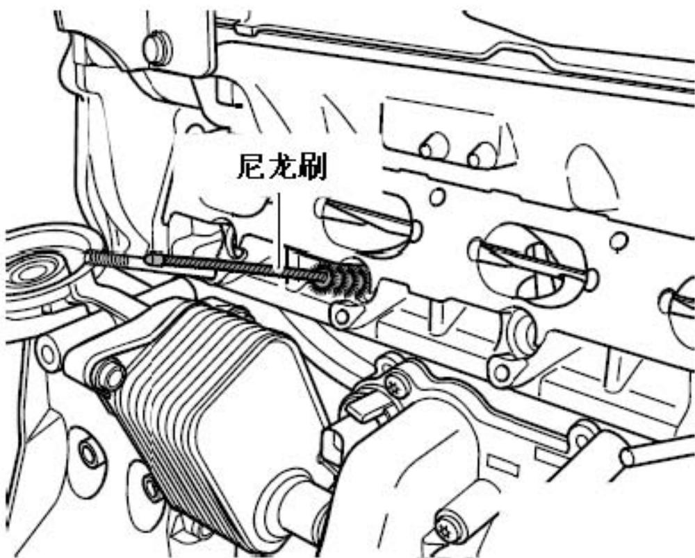
6). 更换喷嘴上的 O 形圈。在安装之前请用干净的发动机油浸润新的 O 形圈(下图 5 所示)。
