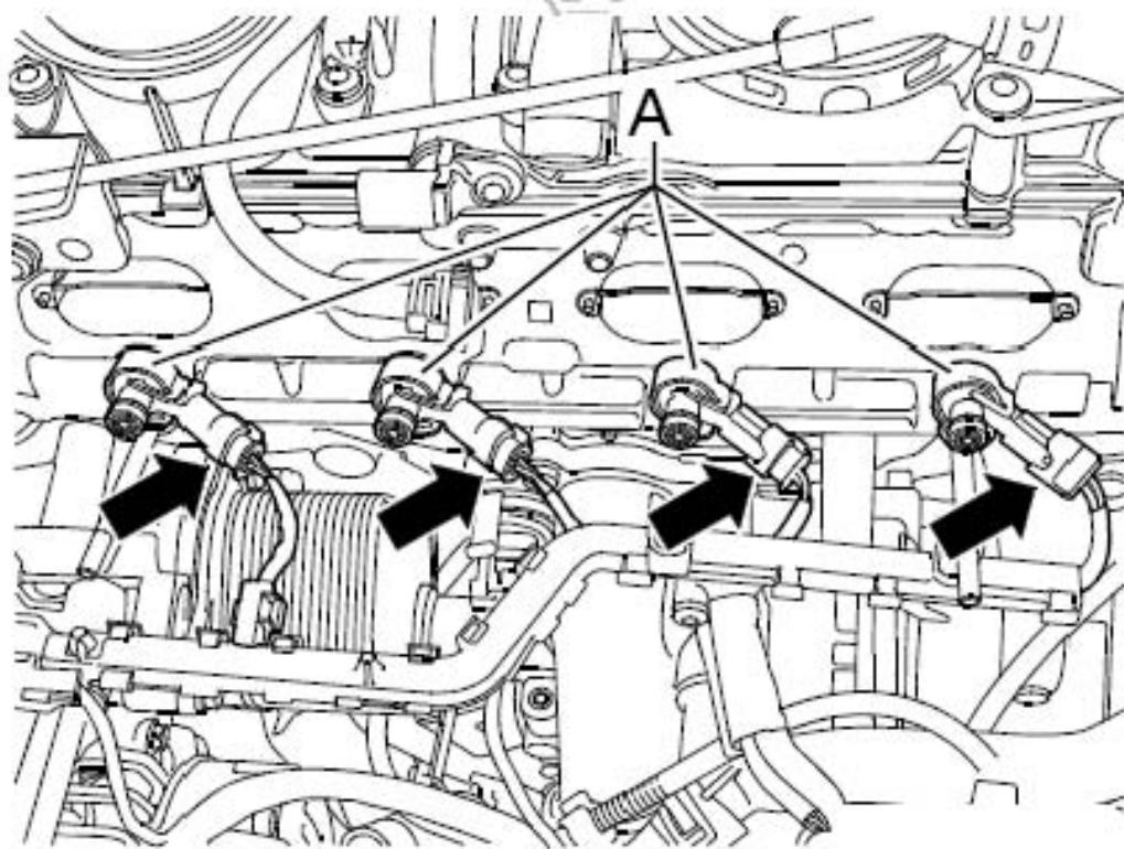
9). 拆卸喷嘴时，必须将限位支撑环（下图 6 所示）从喷嘴上拆下，以便可以将拉出工具导入到喷嘴（下图 3 所示）的切口中。
