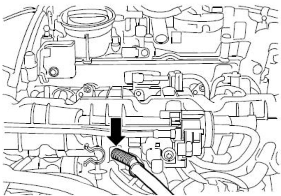
15). 脱开插头连接（下图 1 所示）、（下图 2 所示）和（下图 3 所示）并将插头从支架上取出。旋出螺钉（下图箭头所示），拆下插头支架。
