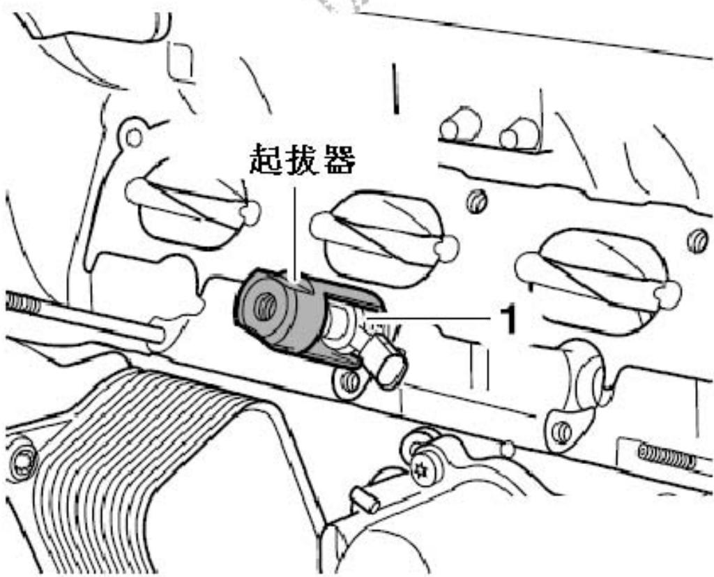
11). 将专用工具用螺栓连接到起拔器上。
