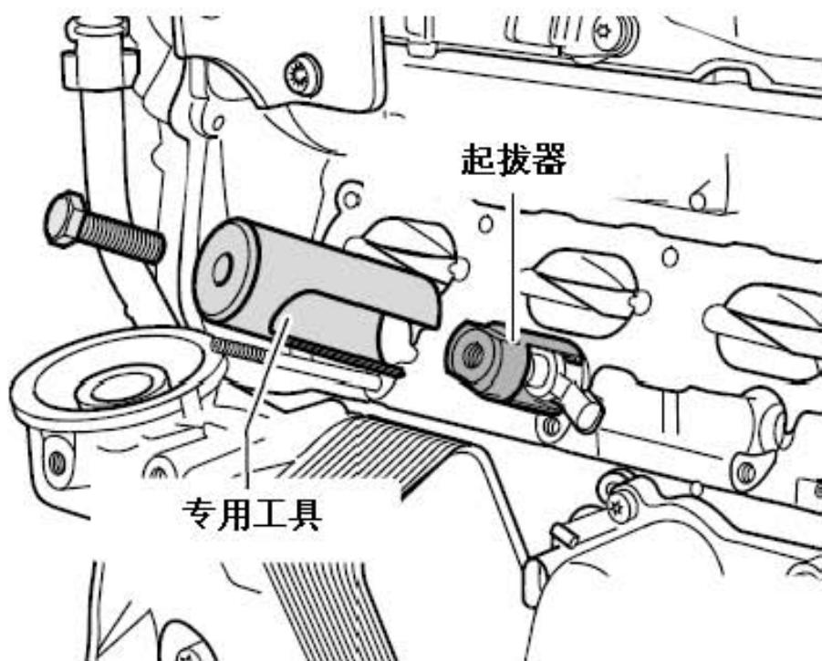
12). 将扳手沿（下图箭头所示）方向轻轻旋转螺栓，直至拉出喷嘴。
