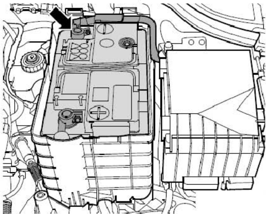
4). 松开固定卡子（下图箭头所示），取下空气导管封盖。
