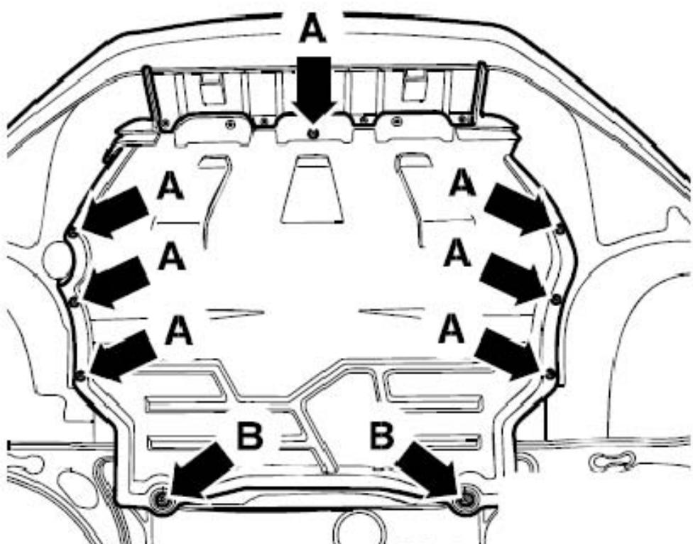
3). 装备四轮驱动的车型, 旋出螺栓(下图箭头 A 所示)和螺钉(下图箭头 B 所示), 取下发动机底部隔音护板。
