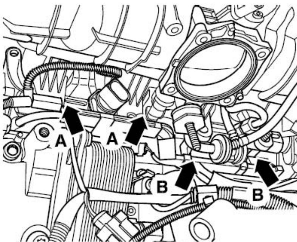
19). 脱开卡子（下图 1 所示）。旋出螺母（下图 A 所示）和螺栓（下图箭头所示），小心地从气缸盖上拔出带有燃油分配器的进气管。
