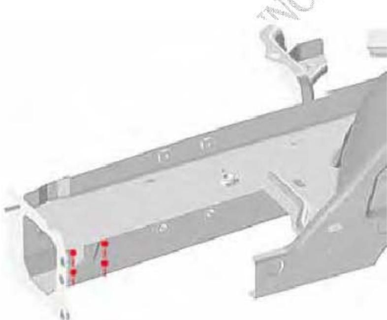
2) . 在贴合边做准备，使用可焊导电涂层保护。
