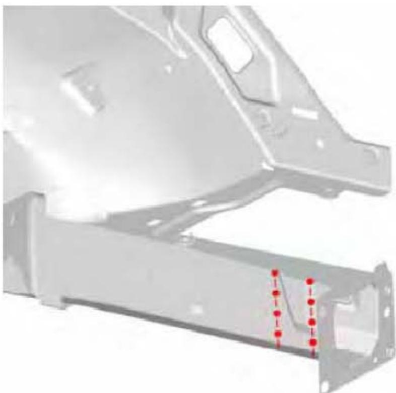
1) . 在贴合边做准备，使用可焊导电涂层保护。
