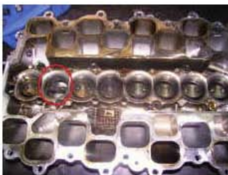
图1 阀板脱落的8号汽缸
