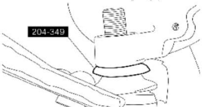
7) . 使用适当的球接头分离器，拆开车轮转向节上的下控制臂，拆卸专用工具。
