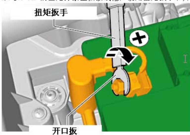
5). 以 9 Nm 的扭矩重新拧紧负极接线柱，使用扭矩扳手和开口扳。如果负极接线柱不牢固：
