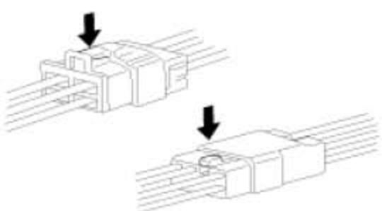
10) 通过插入连接器的方式, 连接带锁扣连接器, 直到能听到咔嚓声。
