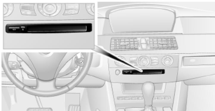
在进行路线计算时，每次进行目的地指引所需要的所有数据都会加载到导航系统的存储器中。在进行目的地指引期间，可以取出导航 CD 光盘 /DVD 光盘。也可以在接通目的地指引后使用音频 CD 光盘驱动器等。假如需要导航 CD 光盘/DVD
