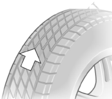
轮纹底部的磨损极限指示(见箭头)分布在轮胎圆周上，在轮胎侧面上用 TWI (轮面磨损指示) 标记。在轮纹深度为 1.6 毫米时出现，即表明轮胎已达到法律所规定的磨损极限。
