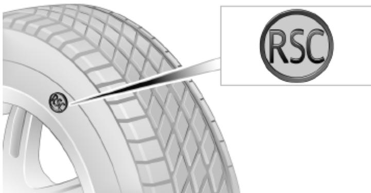
泄气保用轮胎在轮胎侧面上有一个写有“RSC”字样的圆形标记。泄气保用轮胎由自承载式轮胎和特殊的轮辋组成。强化轮胎的目的是，在轮胎失压时甚至压力全无时汽车仍能有限地行驶。
