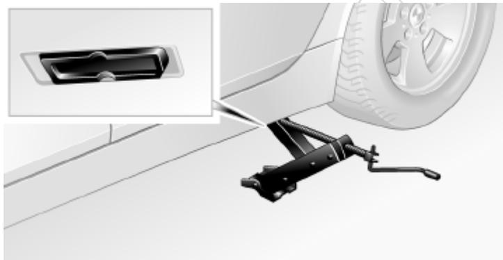
4. 将千斤顶放置在被更换车轮旁的支撑点上,千斤顶底座位于千斤顶支撑点正下方并与整个支撑面垂直,确保千斤顶升起时能使千斤顶头部位位于支撑点的矩形凹口内,见剖面图
