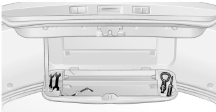
随车工具位于后行李箱盖的下面。松开翼形螺栓即可打开。
