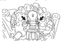
C). 将销拉出发电机电刷座。
