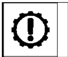
如果指示灯亮起或检查-控制与时钟显示器内显示信息“变速箱紧急模式(TRANS. FAILSAFE PROG)”，说明变速箱系统内出现功能故障。
