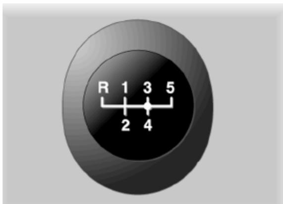
换挡杆顶端标有空档位置（图示圆点），位于 3/4 档之间。
