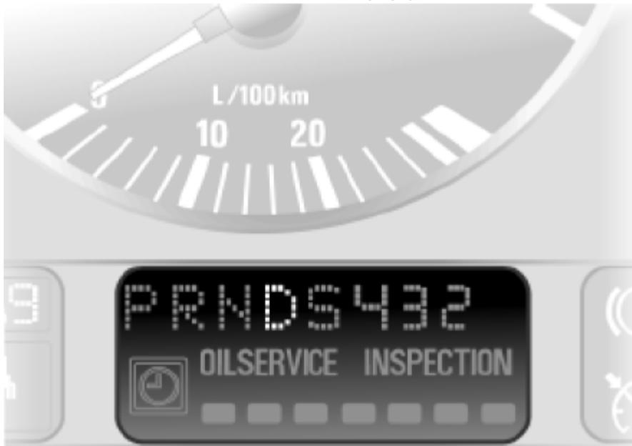
您可以象使用普通自动变速箱一样驾驶汽车，也可以进行手动换档。
