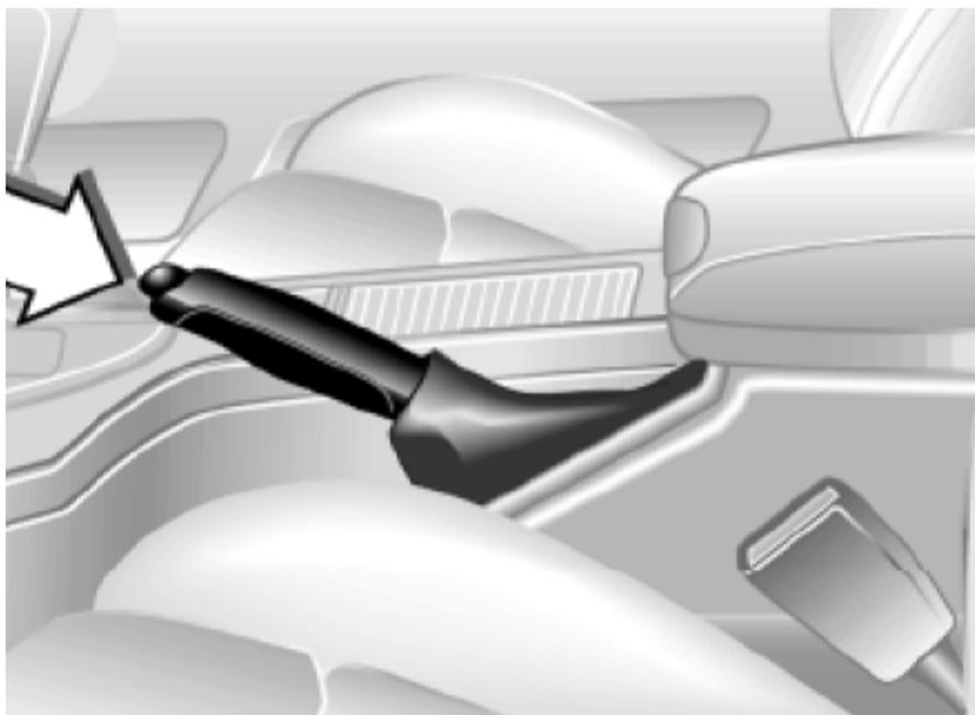
手制动器主要用于防止停着的汽车溜车（作用在后车轮上）。
