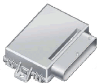
机电式驻车制动器控制单元 J540 (在行李箱内右侧)
