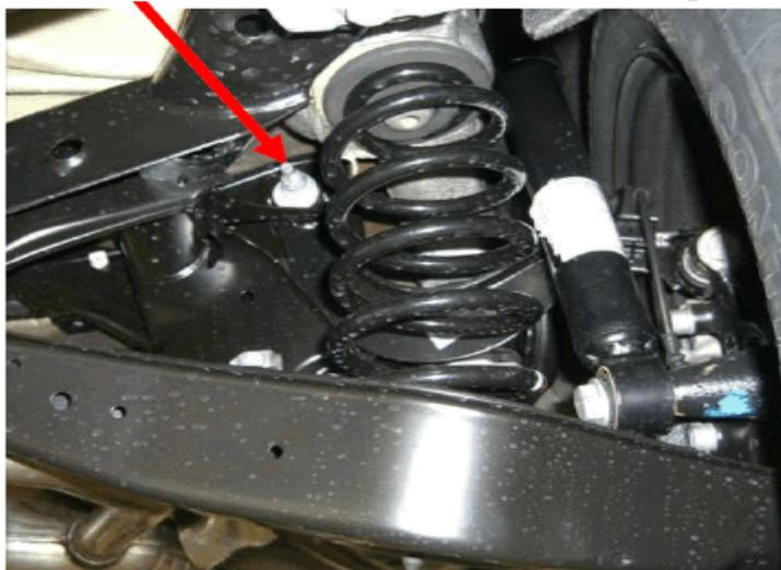
旋转螺栓(下图箭头)调整后轮的外倾角。(专用工具)
