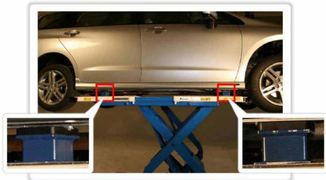
但是，在使用后顶起点顶起车辆时，由于附近有消音器管，故需要注意不要顶到消音器管。
