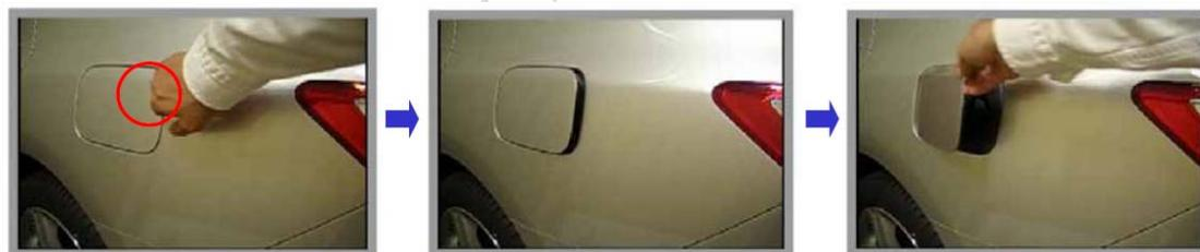
关闭油箱盖时需要注意的是，如果在拉杆伸出的状态下强行关闭油箱盖，可能会导致拉杆或油箱盖变形，故需要注意。
