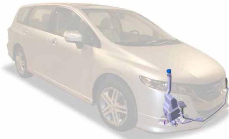
在打开前大灯的状态下打开玻璃清洗器开关，则前大灯清洗器会随之启动一次。
