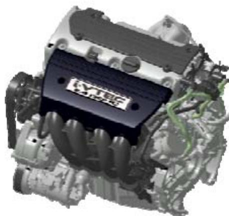
此外，VTC在安装上进行了调整，i-VTEC也变更为可进行高低切换的VTEC。
