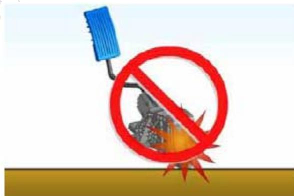
为保护钼层以及防止节气门位置传感器和节气门执行元件出现故障，请勿将清洁剂直接喷洒在节气门阀轴承部位进行清洗。
