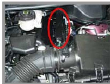
与前款车型相同，PCM进行版本升级时，可使用本田诊断系统（Honda Diagnostic System）（HDS）进行更新。
