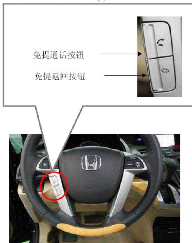
2009 ODYSSEY的部分车型即使是新装音响系统的车型（非HDD导航系统配置车）也可通过方向盘上的操作开关使用蓝牙通信中的免提功能。
