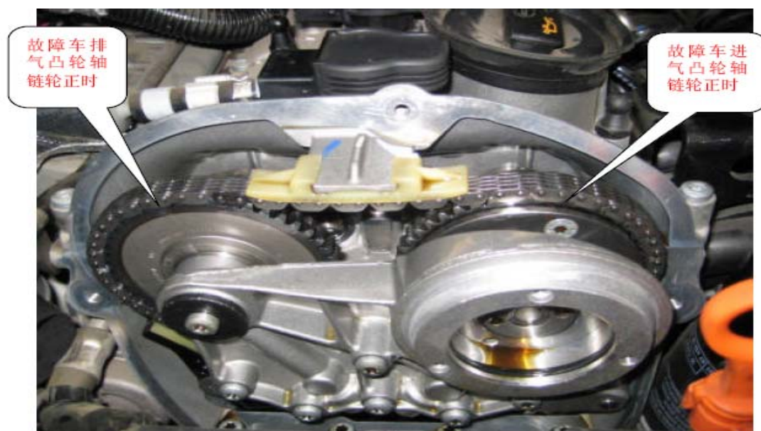
图2：故障车进、排气凸轮轴链轮正时
