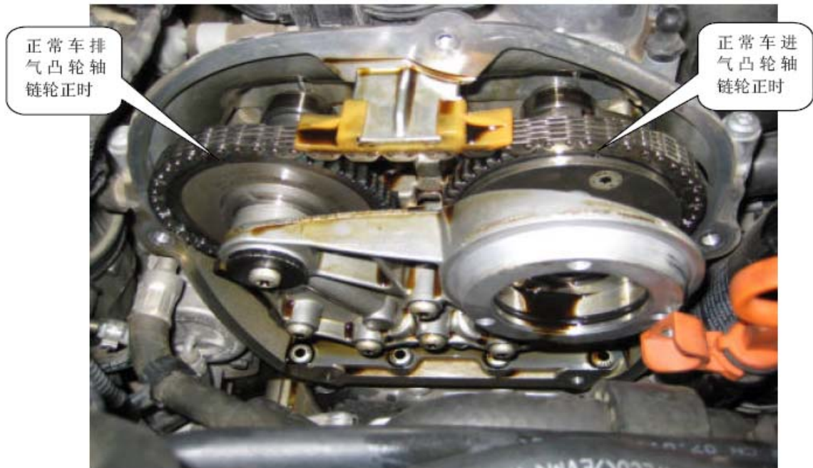
图3：正常车进、排气凸轮轴链轮正时
