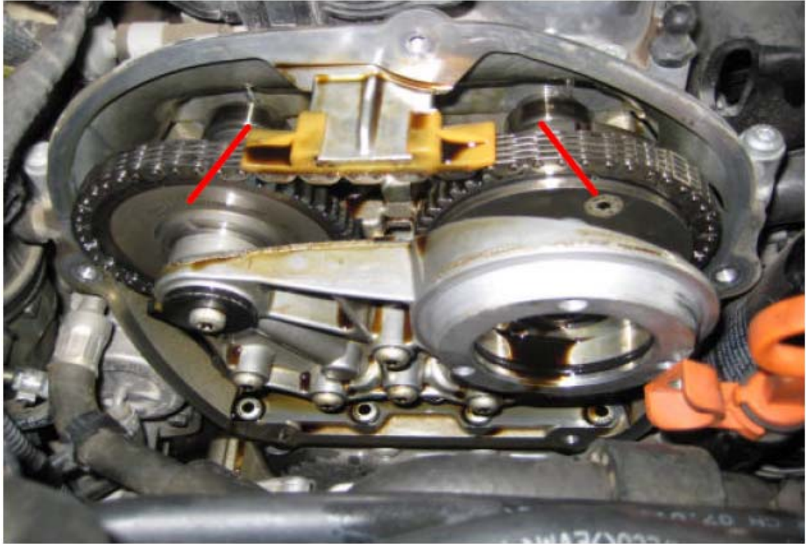
图7：同类型商品车第一缸进排气凸轮能形成“八”字
