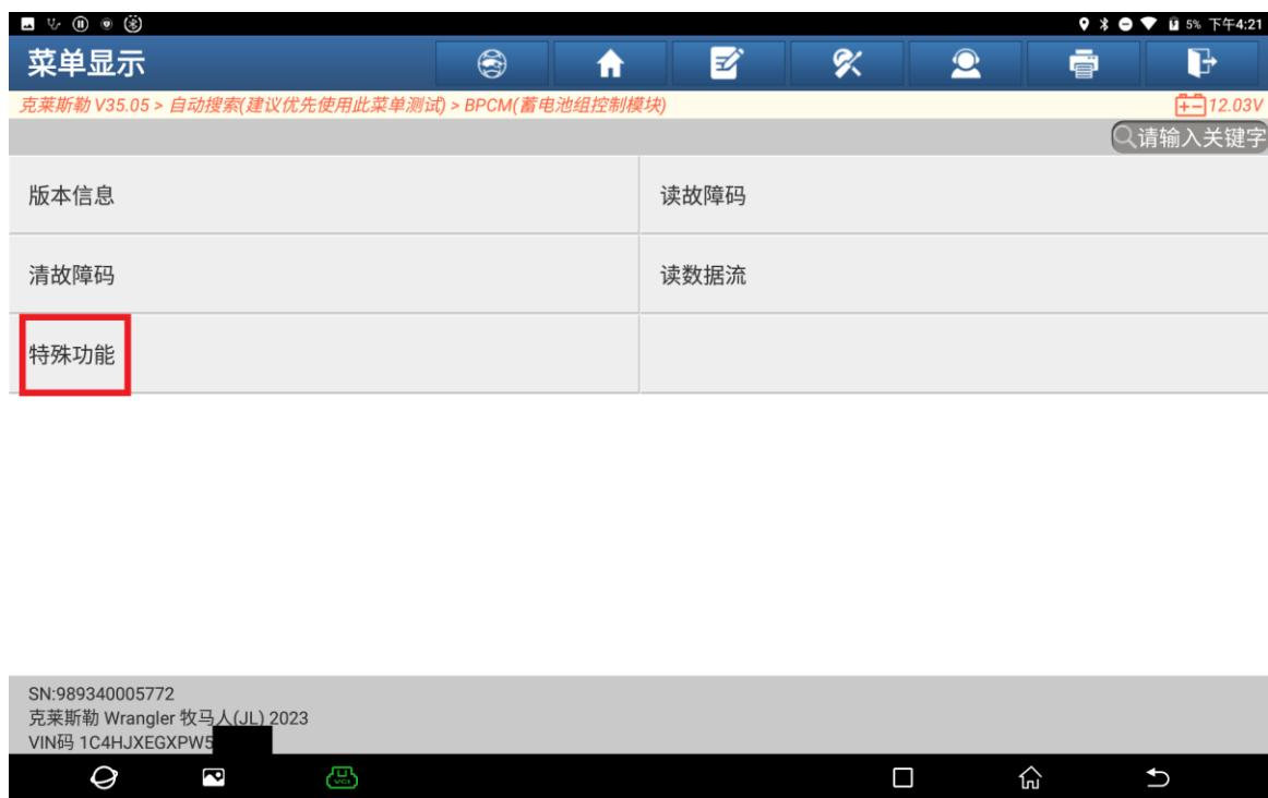
9. 点击功能【禁用 HV(混合驱动车辆) 电池接触器】;
