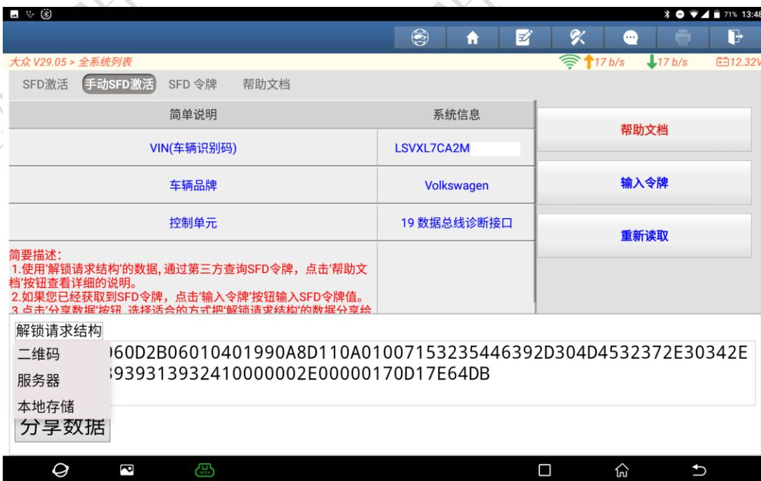
7. 首先介绍“服务器”分享方式，选择服务器选项，将“解锁请求结构”的数据分享到服务器，点击确定后用手机的微信/支付宝等扫描二维码或者直接在手机或者电脑的网络浏览器中输入网址，进入数据共享界面；
