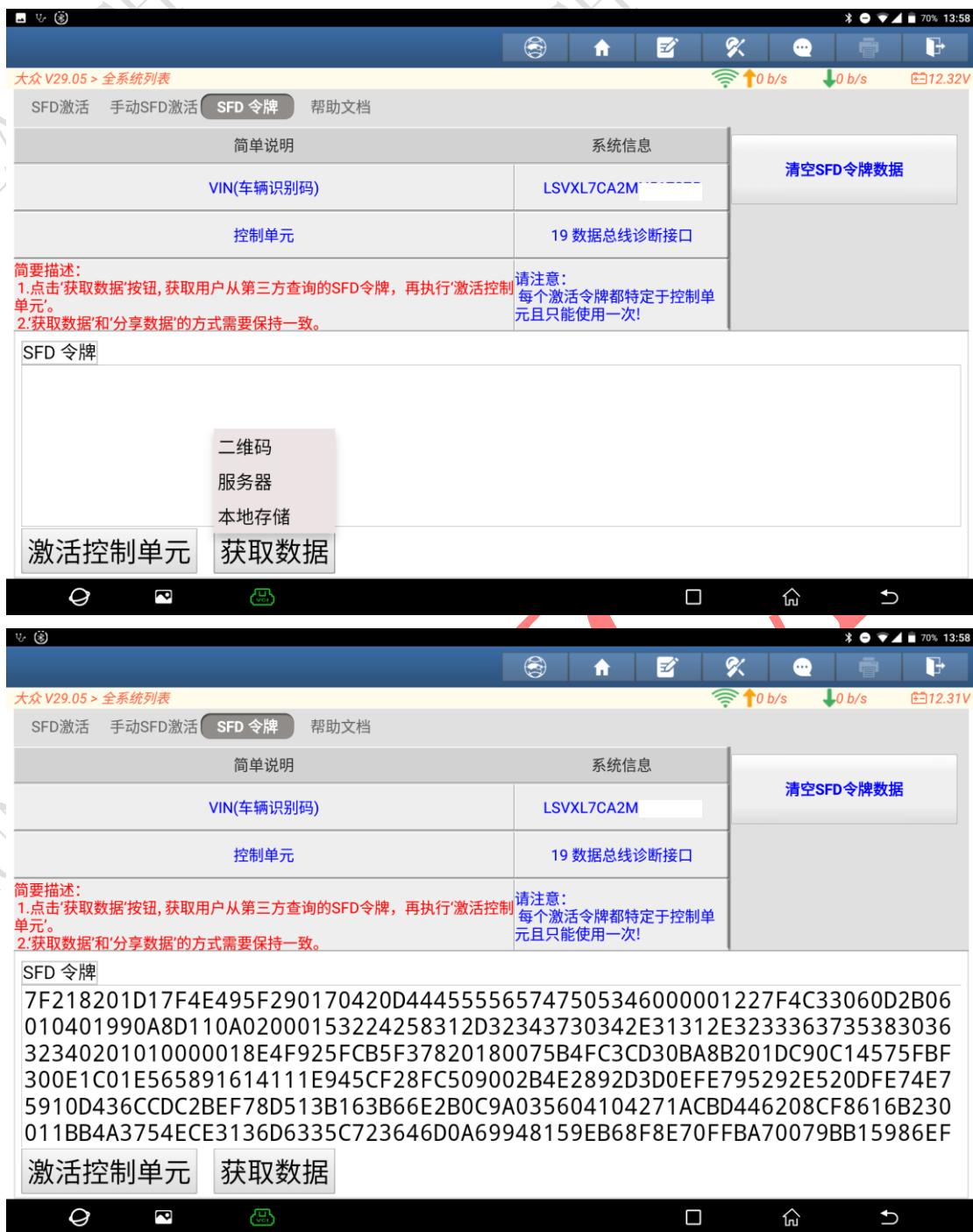
11. 获取到 SFD 令牌数据后，点击“激活控制单元”按钮进行解锁，解锁成功如下图所示；
