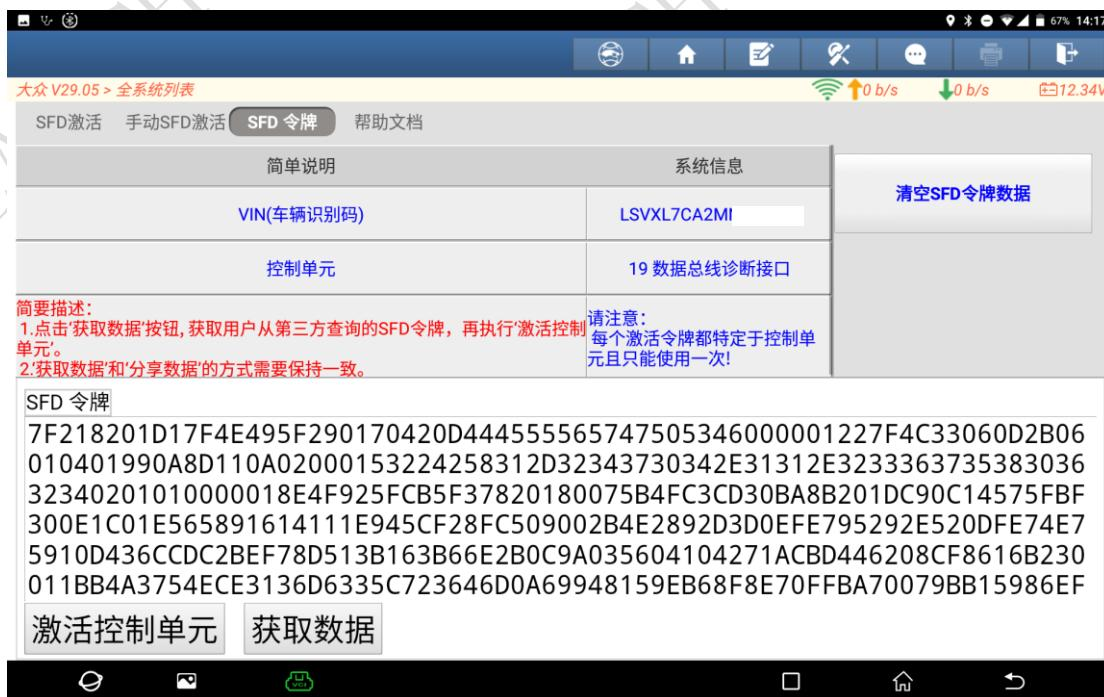
18. 点击【激活控制单元】按钮, 解锁成功; 接下来可以返回菜单执行相应的诊断功能。
