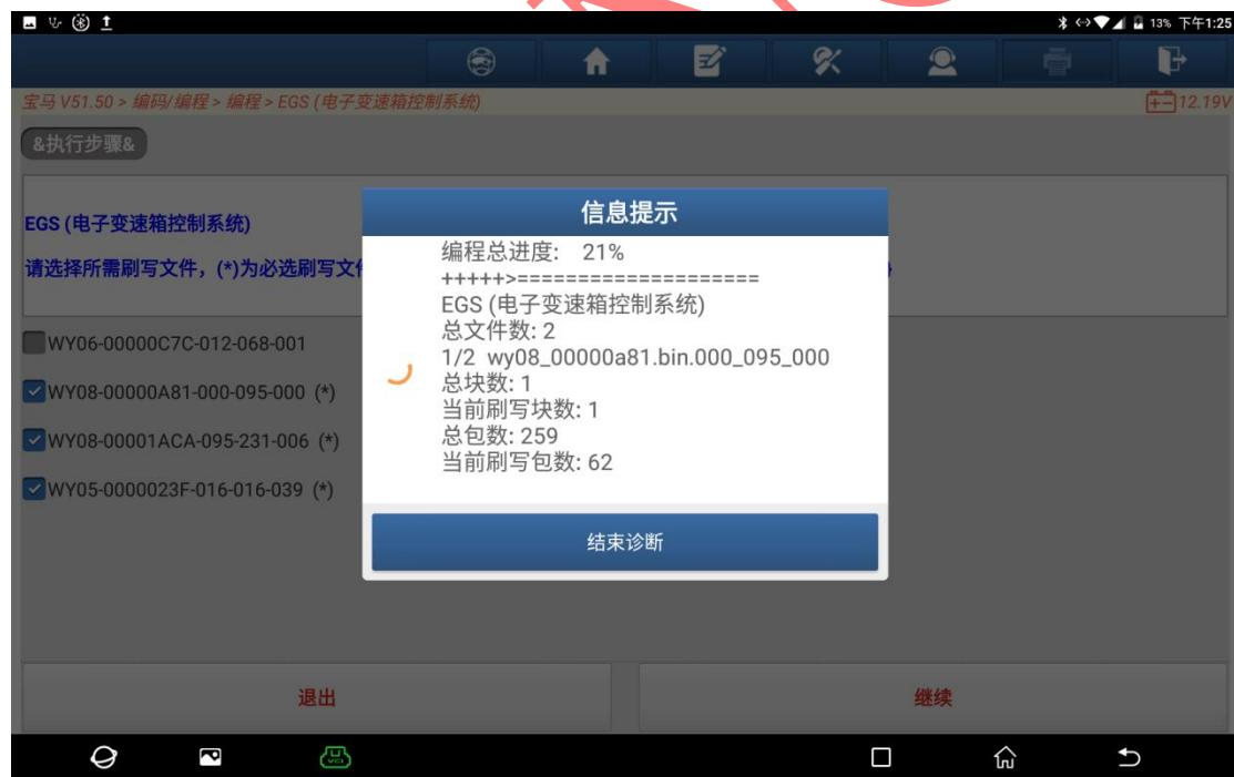
18. 执行到 100%后，自动跳转提示“车辆编程状态退出中”（如下图）；
