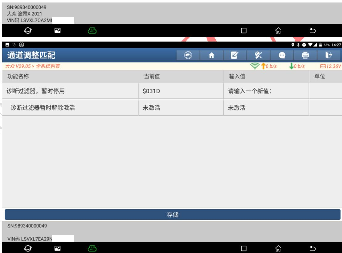
17. 点击“存储”按钮，诊断过滤器暂时解除激活”的当前值变为“激活”，则诊断防火墙停用操作完成；可以返回菜单执行相应的诊断功能。
