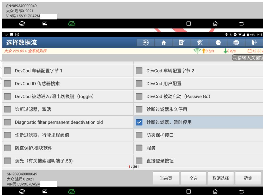
15. 此时如果“诊断过滤器暂时解除激活”的当前值为“激活”，见下图，说明诊断防火墙已停用，可以返回菜单执行相应的诊断功能。
