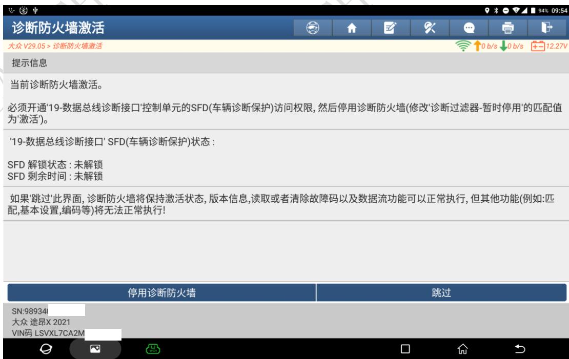
4. 点击【停用诊断防火墙】按钮，首先执行 19 系统的 SFD(车辆诊断保护)激活功能；
