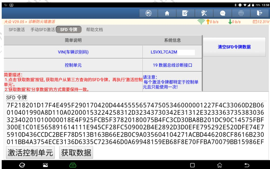
11. 获取到 SFD 令牌数据后，点击“激活控制单元”按钮进行解锁；解锁成功，如下图所示：
