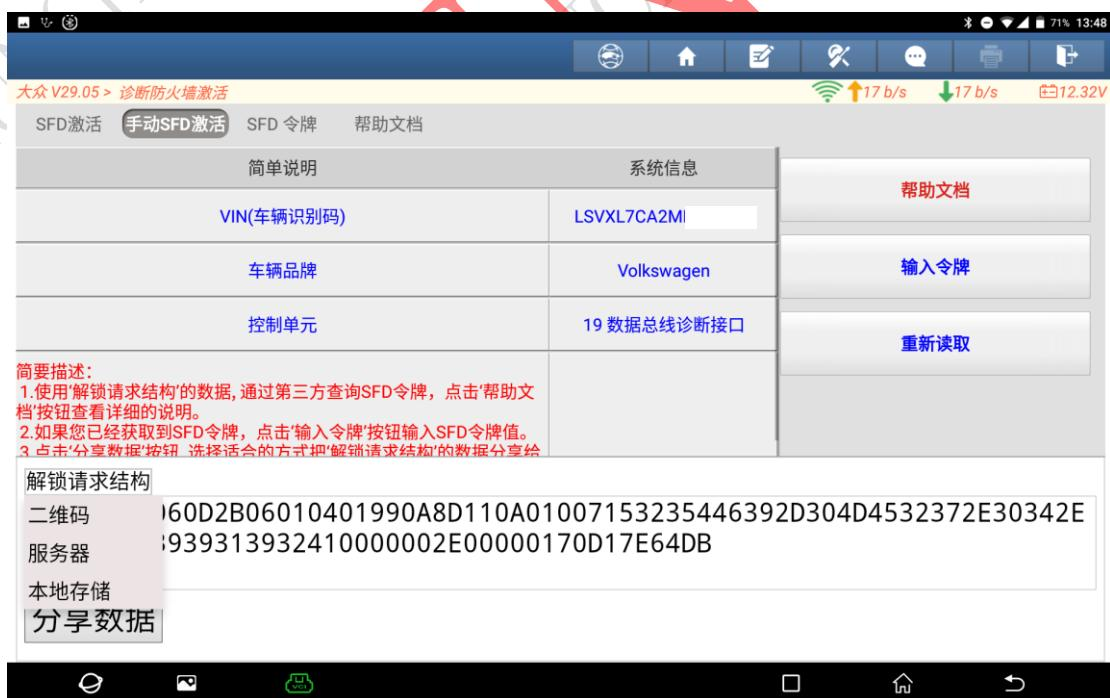
7. 选择服务器选项，将“解锁请求结构”的数据分享到服务器，点击确定后用手机的微信/支付宝等扫描二维码或者在手机或者电脑的网络浏览器上输入网址，进入数据共享界面；
