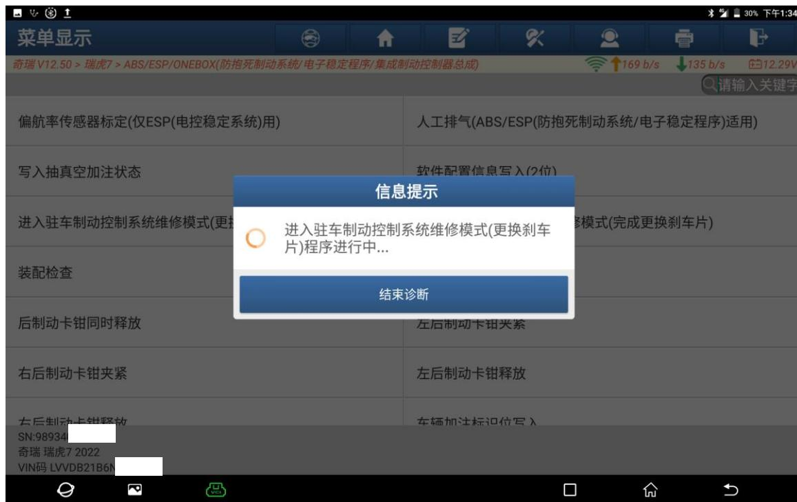
6. 进入驻车制动控制系统维修模式（更换刹车片）已完成。完成后可更换刹车片；
