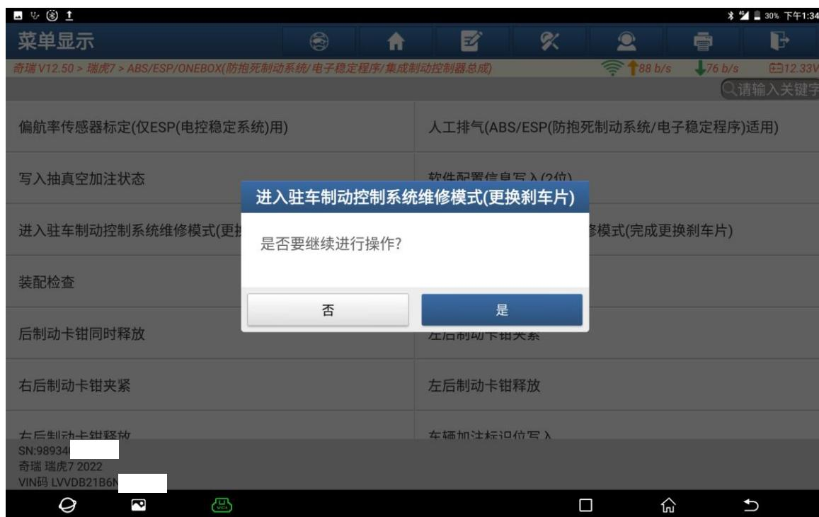
5. 进入驻车制动控制系统维修模式（更换刹车片）程序进行中... （如下图）：
