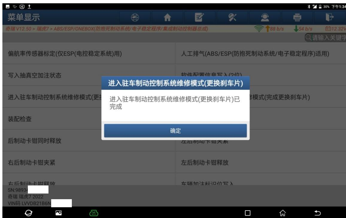
7. 更换后点击【退出驻车制动控制系统维修模式（更换刹车片）】(如下图);
