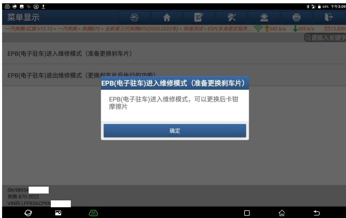
7. 更换好后选择【EPB(动作驻车)退出维修模式 (更换刹车片后执行的功能)】(如下图);
