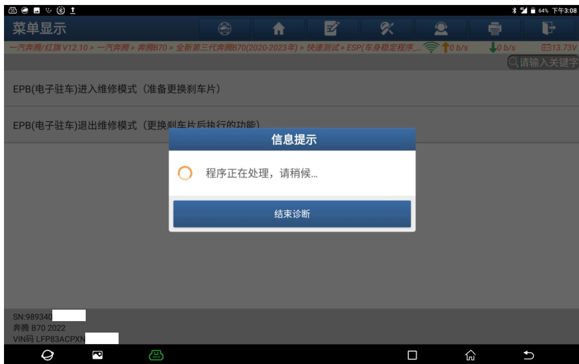
6. EPB(电子驻车)已进入维修模式, 可以更换后卡钳摩擦片(如下图);
