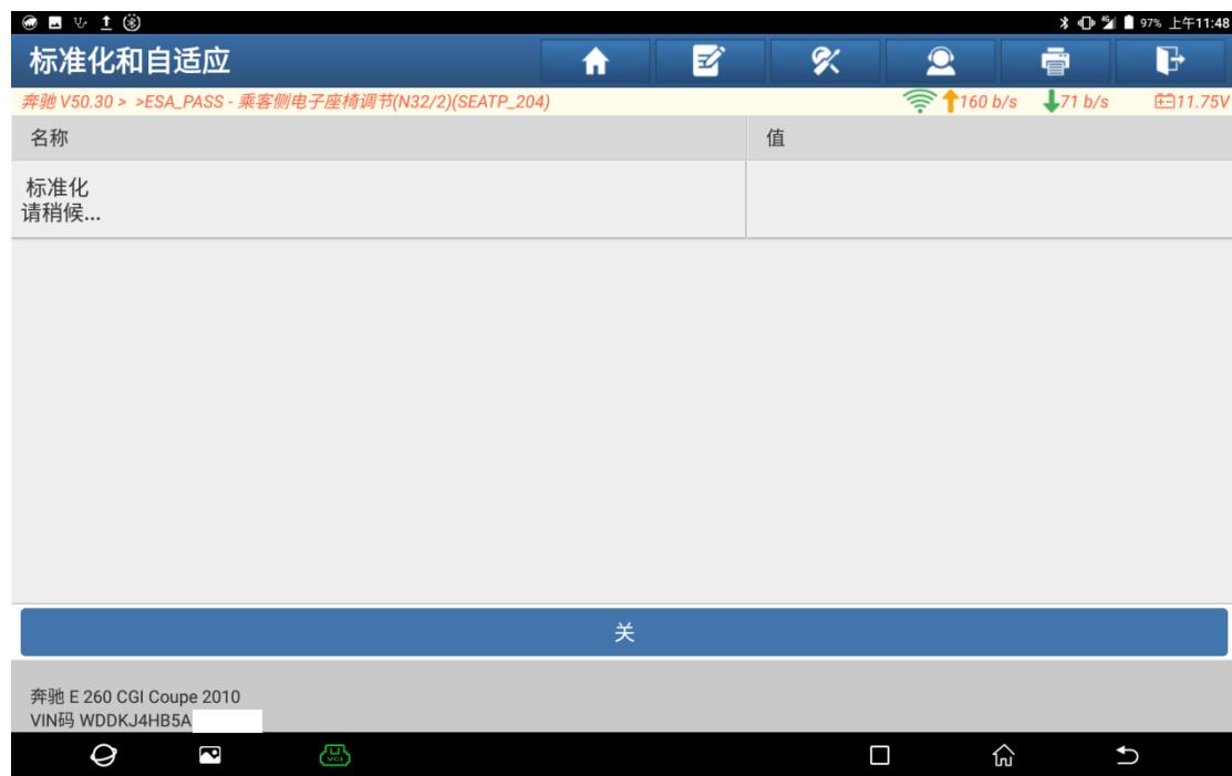
9. 提示“已成功进行标准化，调整已成功运行”，点“确定”校准结束(如下图)。
