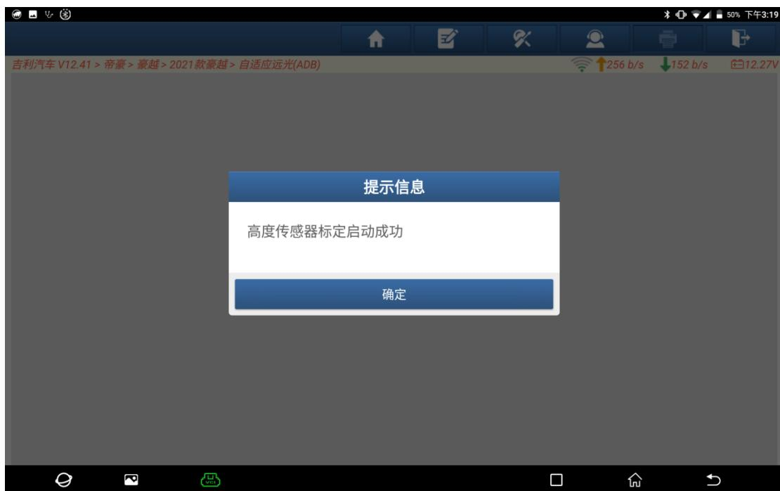
9. 提示“高度传感器标定成功”，点“确定”校准结束（如下图）。
