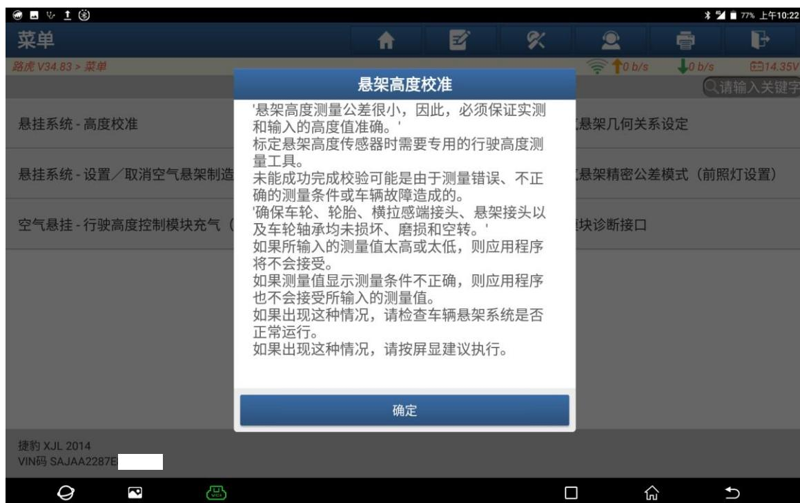
7. 确保胎压正常，地面平整，关闭所有车门（如下图）。
