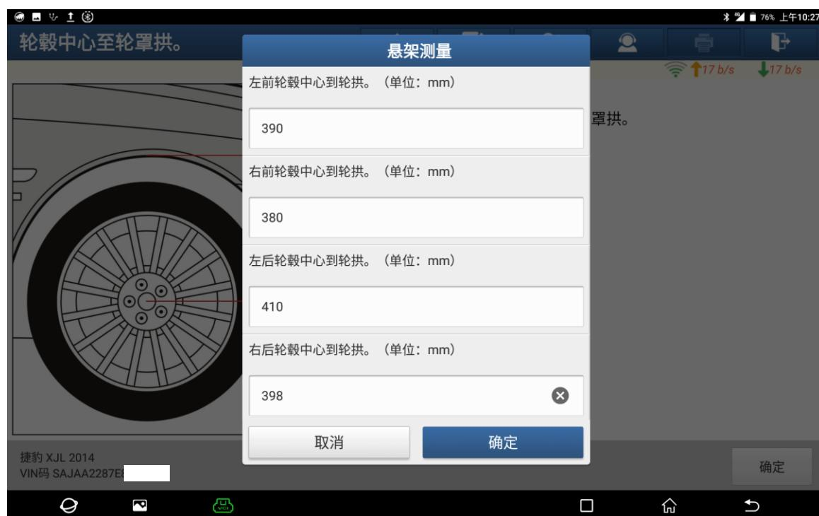
14. 如高度测量值超出要求的公差，重试将要求重新测量悬架高度（如下图）：
