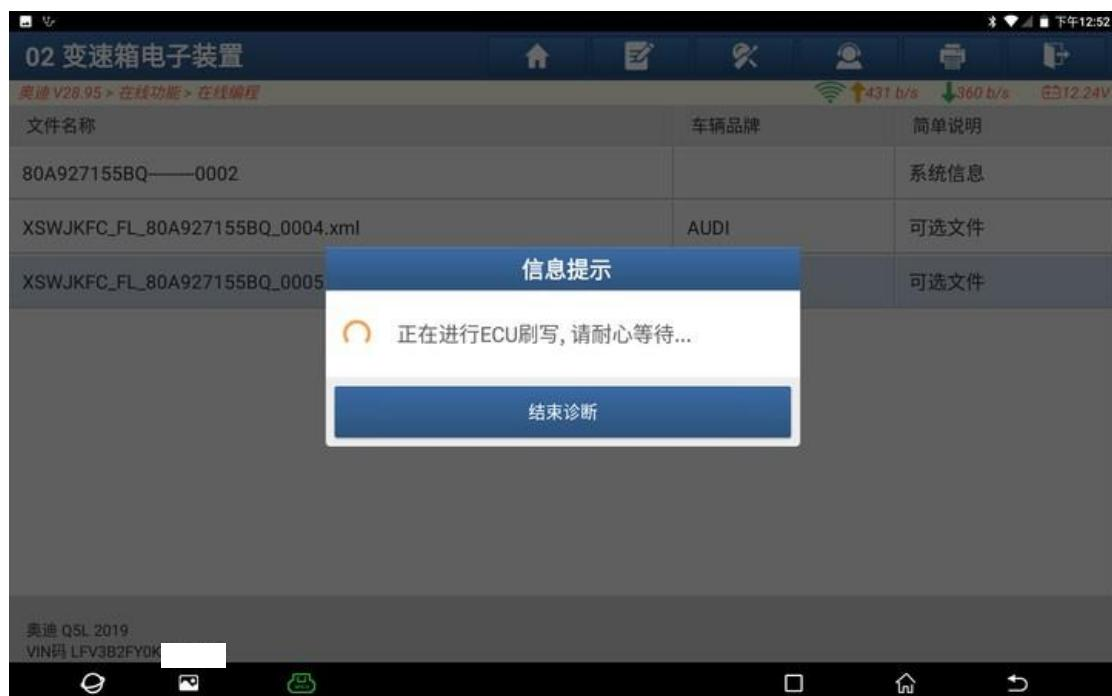
14. 刷写完成后，关闭点火开关，等待 30 秒后再次打开点火开关，然后点击“确定”；
