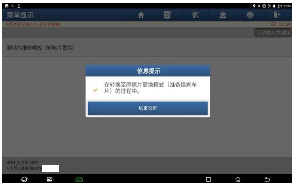
7. 维修模式切换完成，现在可以正常更换刹车片，更换完成后，点击“确定”；
