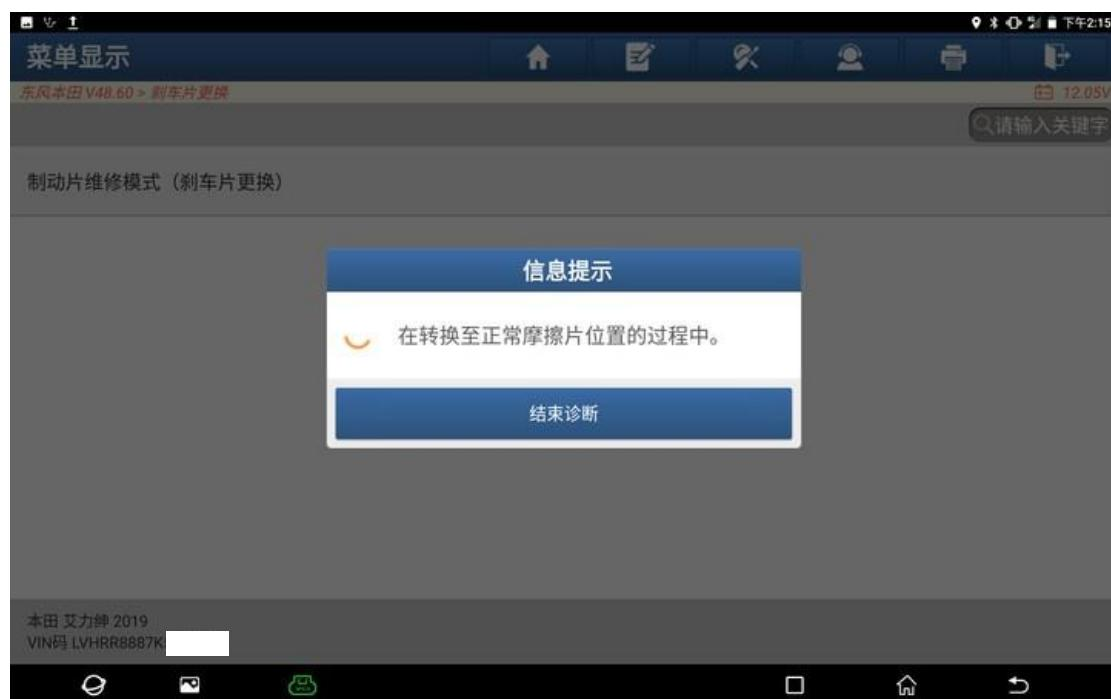
11. 维修模式退出成功，点击“确定”刹车片更换已完成；
