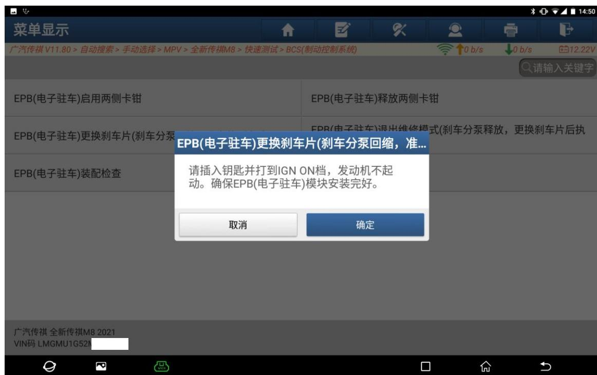
5. 请将车辆停放在平整的地面上，并确认 EPB (电子驻车) 处于释放状态。点击“确定”（如下图）；
