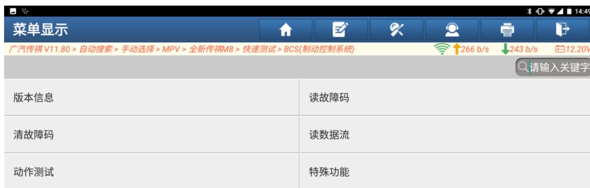
3. 选择【EPB(电子驻车)更换刹车片(刹车分泵回缩, 准备换刹车片)】(如下图);
