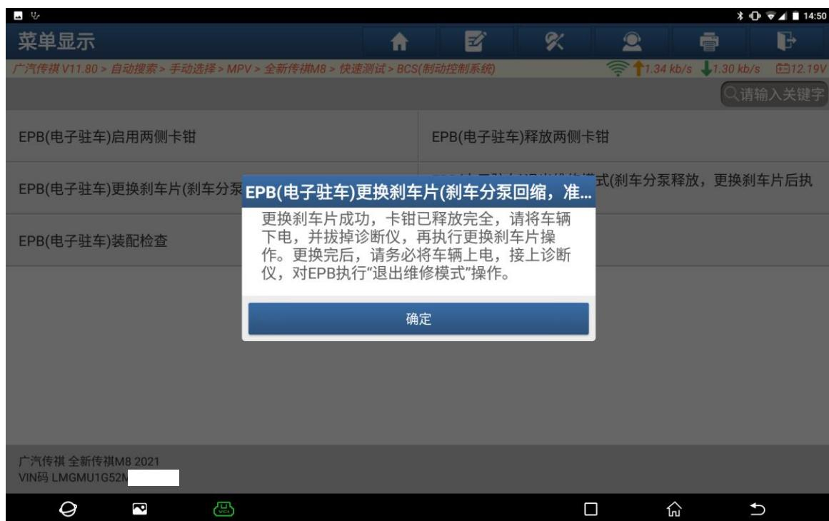
7. 更换完后选择[EPB(电子驻车)退出维修模式（刹车分泵释放，更换刹车片后执行的功能）（如下图）；
