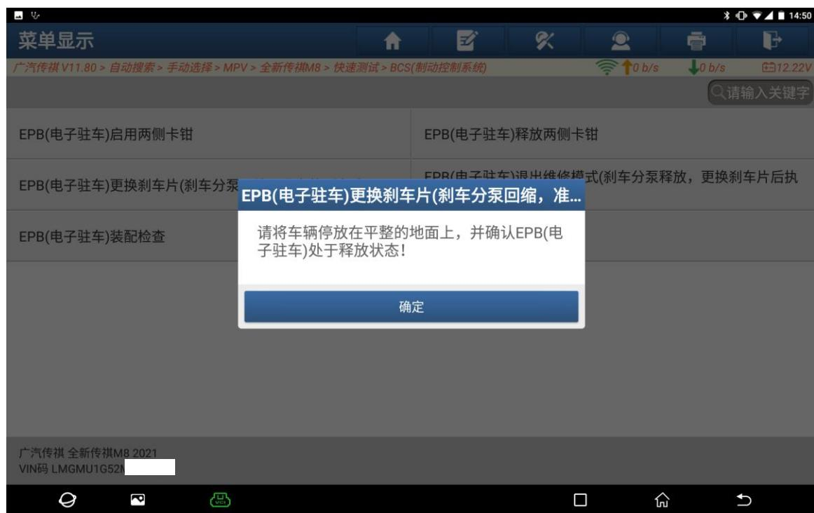
6. 卡钳已释放，更换完后执行“退出维修模式”（如下图）；
