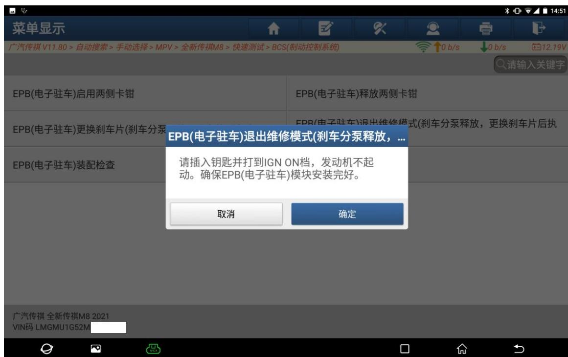
9. 请将车辆停放在平整的地面上，并确认 EPB (电子驻车) 处于释放状态。点击“确定”（如下图）。
