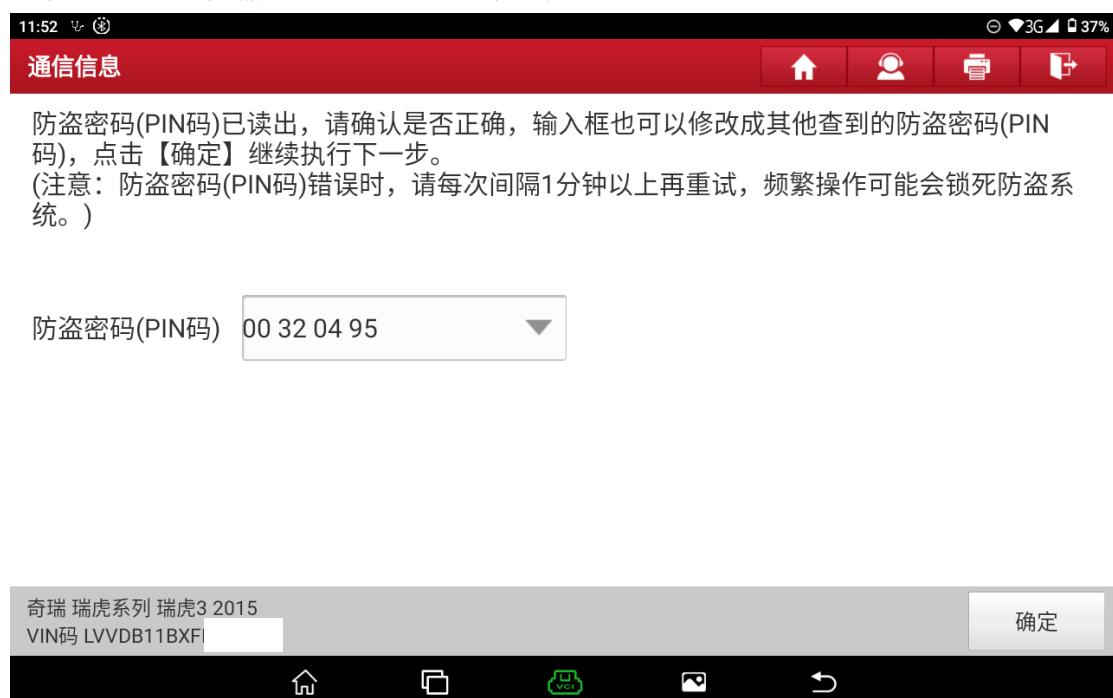
复位发动机控制模块 (ECM) (清除发动机系统匹配信息) 执行状态 (如下图)
