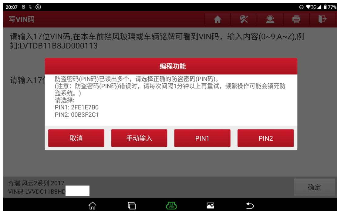
提示信息: 防盗控制器识别码 PIN 码写入状态 (如下图)
