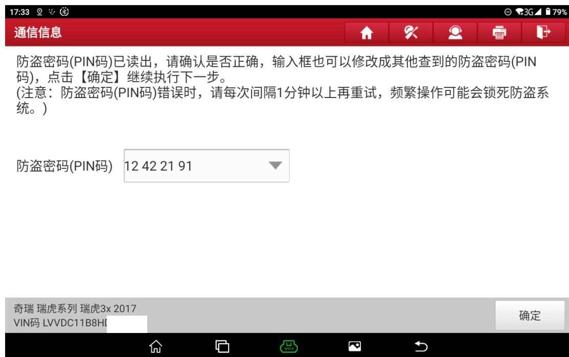
更换电子转向柱锁 (ESCL) 执行状况 (如下图)
