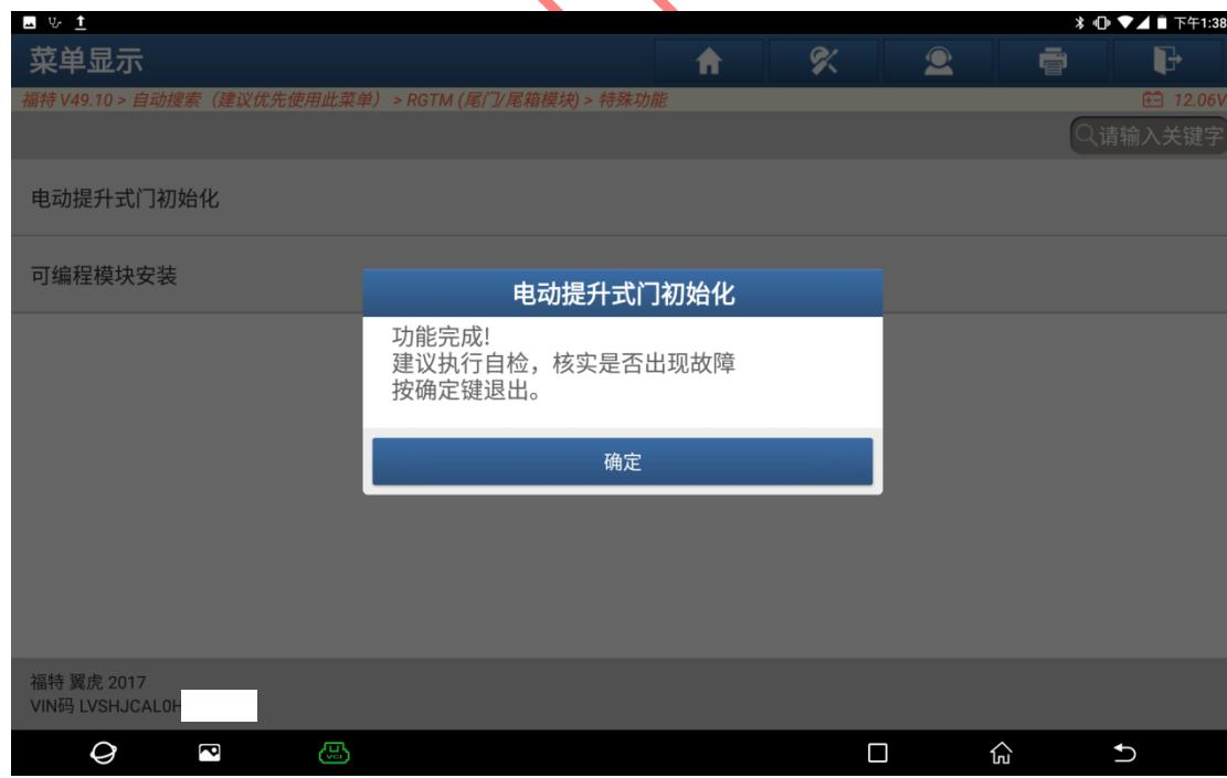
14. 清除一遍故障码，重新读码，显示正常无码，校准完成（如下图）。
