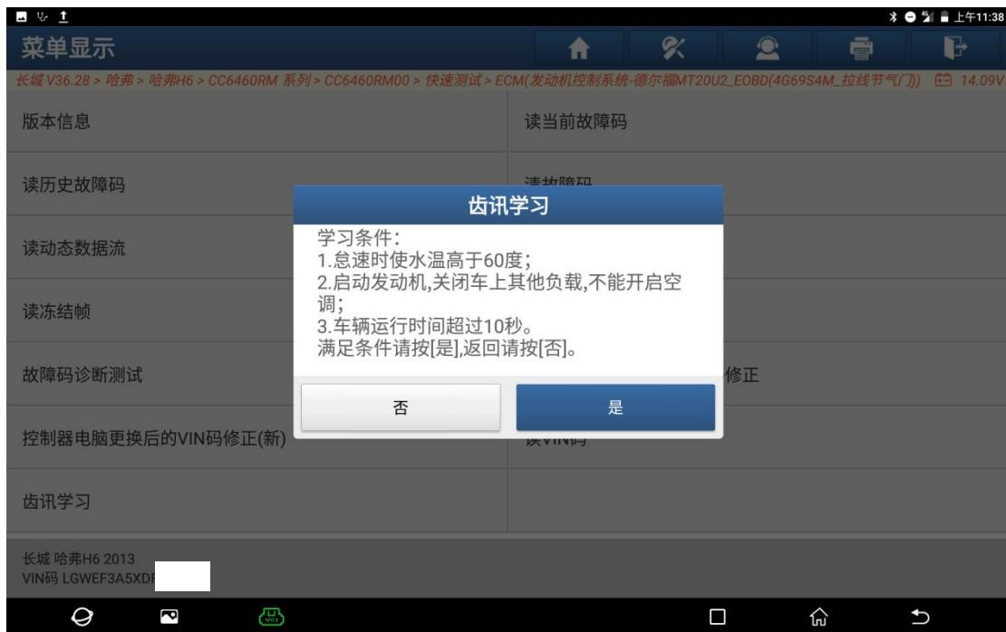
11. 按提示操作，“将油门迅速踩到底不松开，10 秒内发动机转速在“1500~5000”之间反复变化 3~5 次，然后松开油门，超过 10 秒也要松开油门”，松开油门踏板后点“确定”(如下图);
