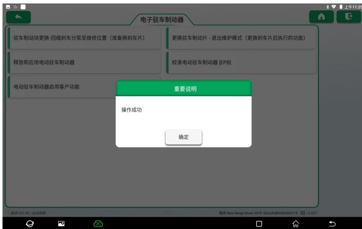
10. 操作成功后可更换刹车片。更换好后选择【更换驻车制动片-退出维修模式（更换刹车片后执行的功能】(如下图)。
