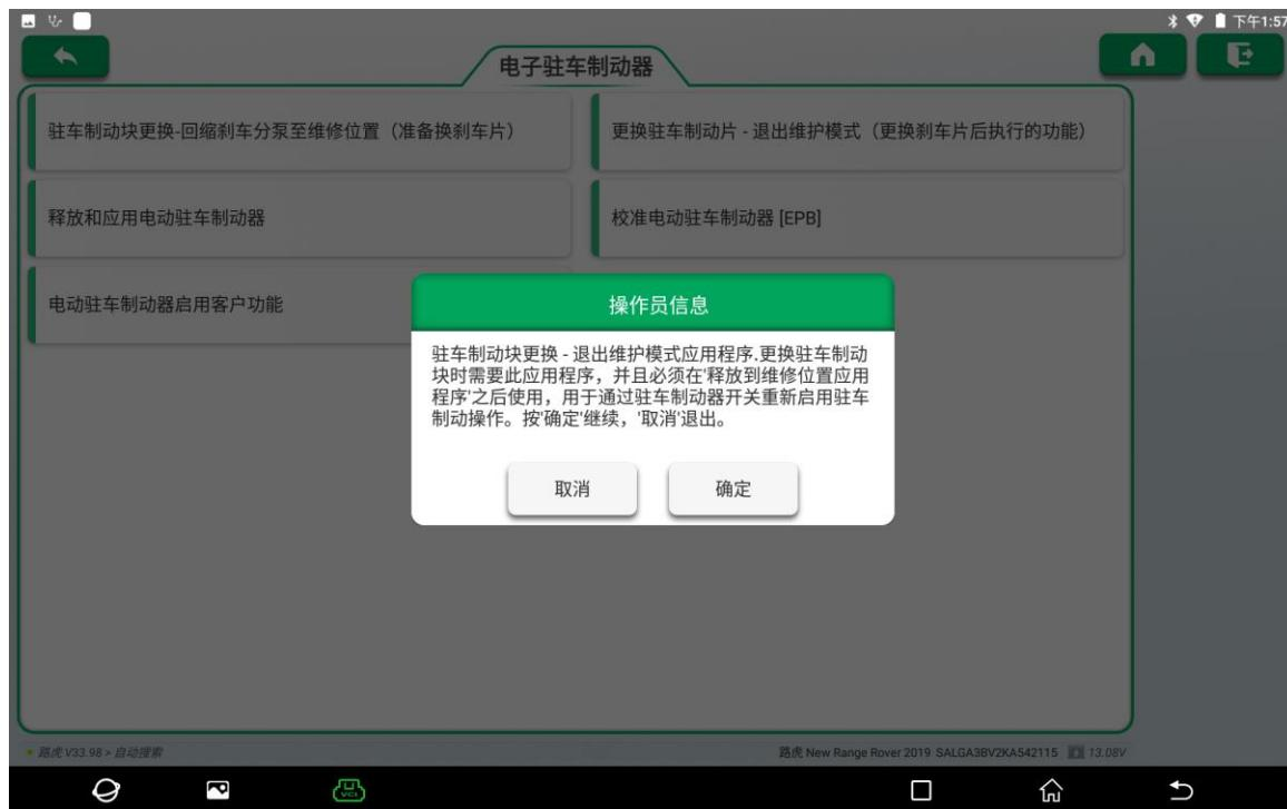
12. 确保车辆在水平地面处于静止状态，释放驻车制动器。点击“确定”（如下图）。
