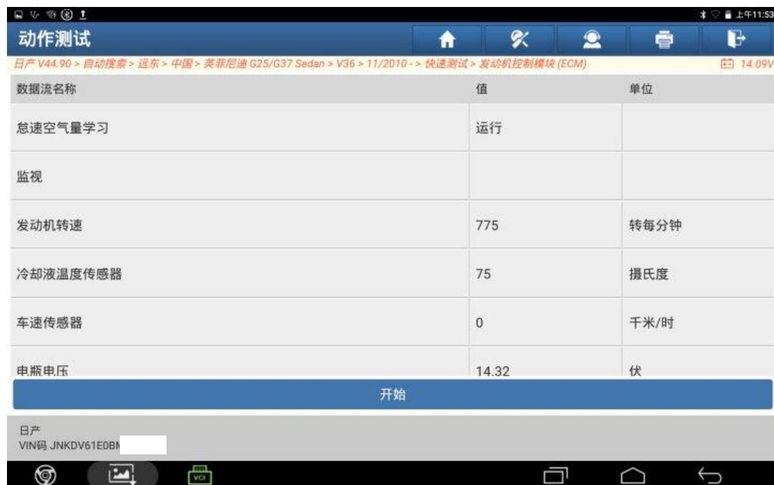
10.怠速空气量学习显示【完成】，发动机转速停留在正常水平；
