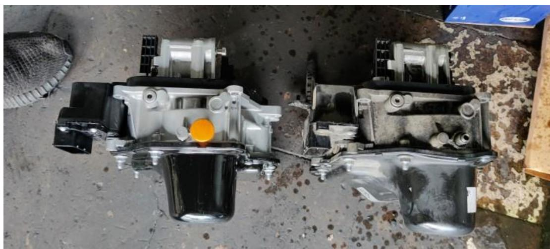
8. 更换全新机电单元后，变速箱模块有多个故障码，需要对机电单元进行基本设置。
