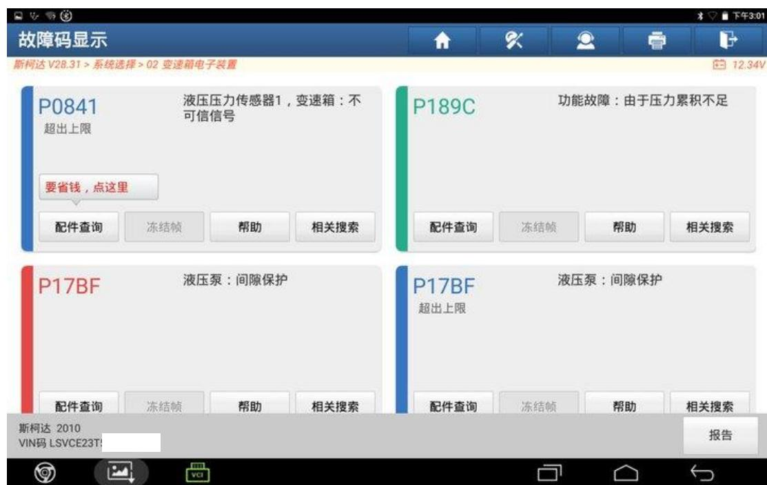
6. 变速箱模块存在一个【P189C 功能故障，由于压力累积不足】，根据故障码分析，变速箱机电单元存在泄压现象，可能的原因有 1. 液压油泄露 2. 机电单元内部故障 3. 机电单元 ECU 损坏。
