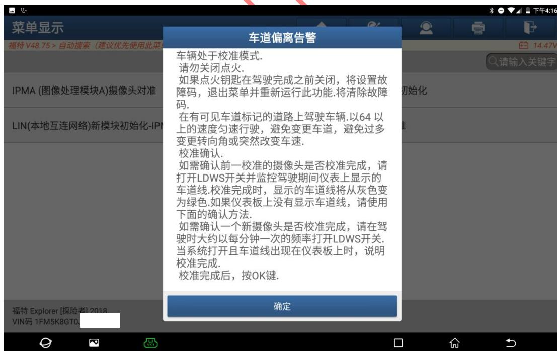
12. 路试过程中，查看车辆仪表，前摄像头故障提示已经消失，摄像头校准成功（如下图）；
