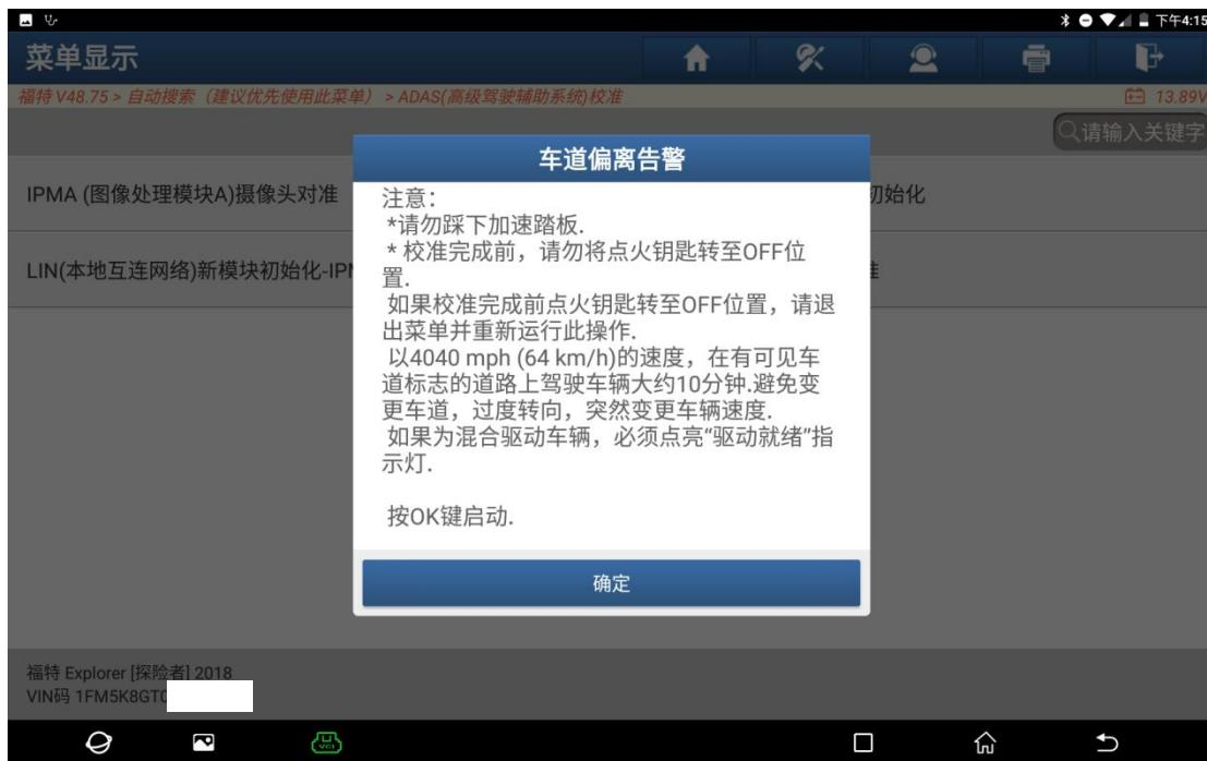
11. 阅读提示，根据提示信息路试，同时根据提示信息确认是否校准完成，一直保持该界面，校准完成后点“确定”（如下图）；
