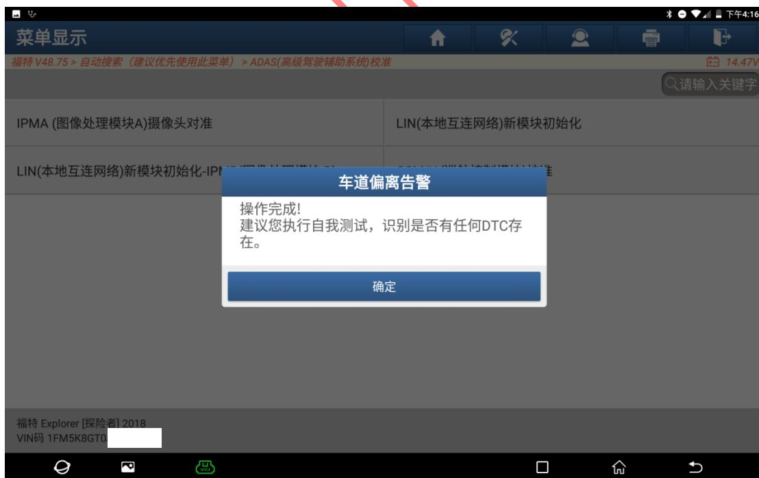
14. 提示“关闭点火开关”，找个可以安全停车的地方在关闭，关闭后点“确定”，校准结束（如下图）。
