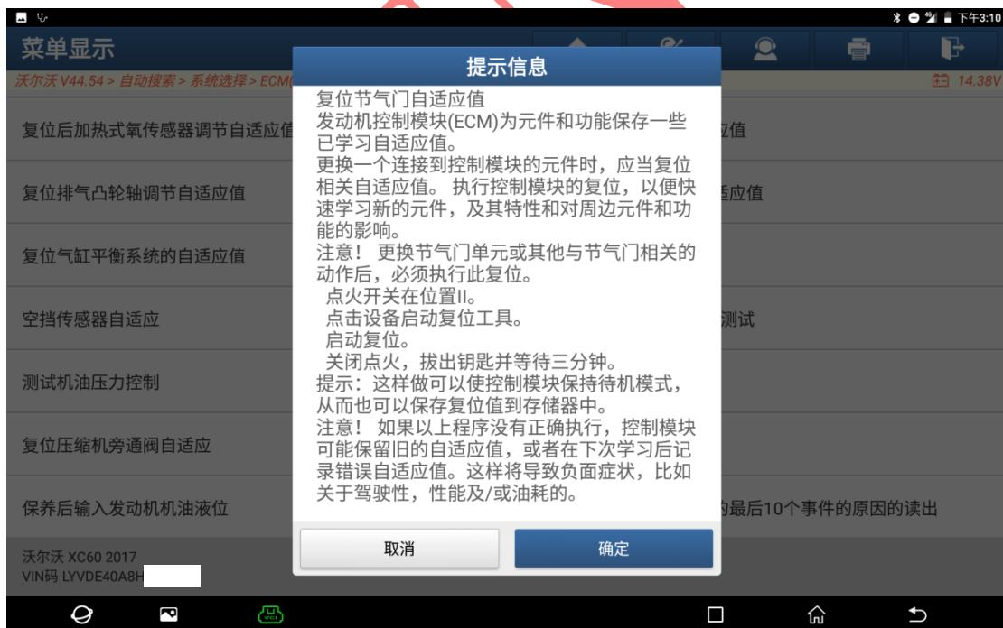
8. 学习成功后提示“已执行”，点“确定”后关闭点火开关等待 3 分钟（如下图）；
