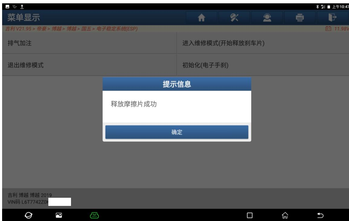
6. 此时更换后刹车片，更换后选择【退出维修模式】(如下图);
