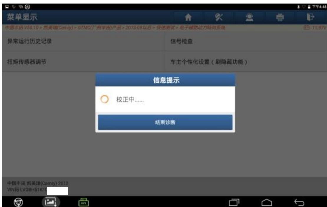
17. 将方向盘往左转动 90° 后，再往右转动 90°，然后居中，点击“确定”；
