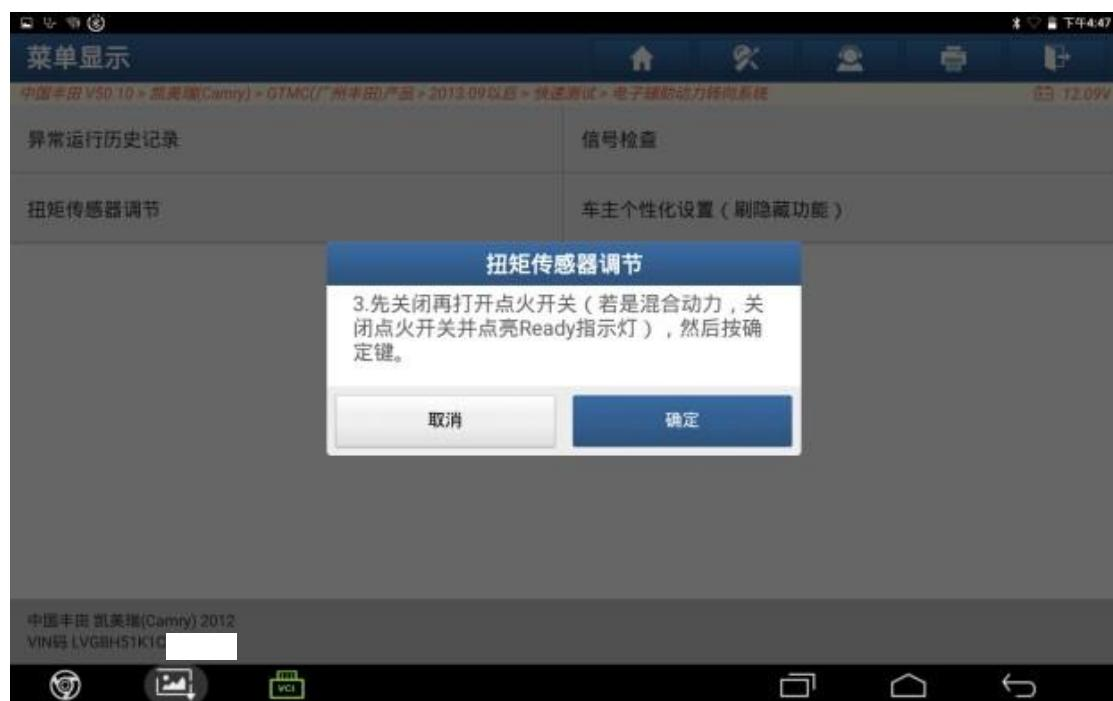
13. 确定仪表转向故障灯点亮后，点击【确定】：
