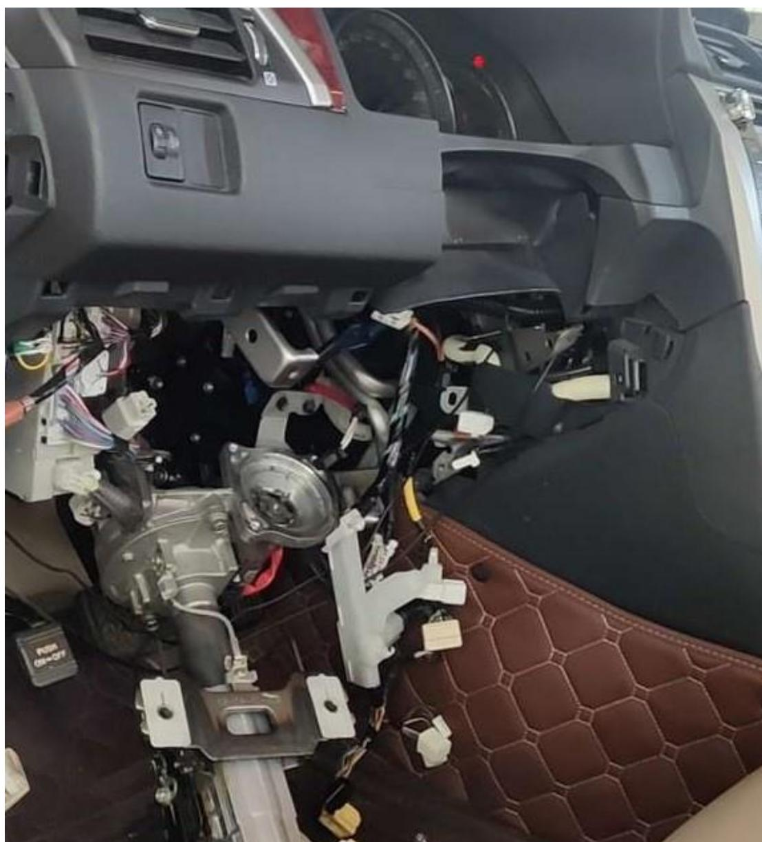
2. 转向助力电机齿轮连接处塑料齿轮已经损坏；
