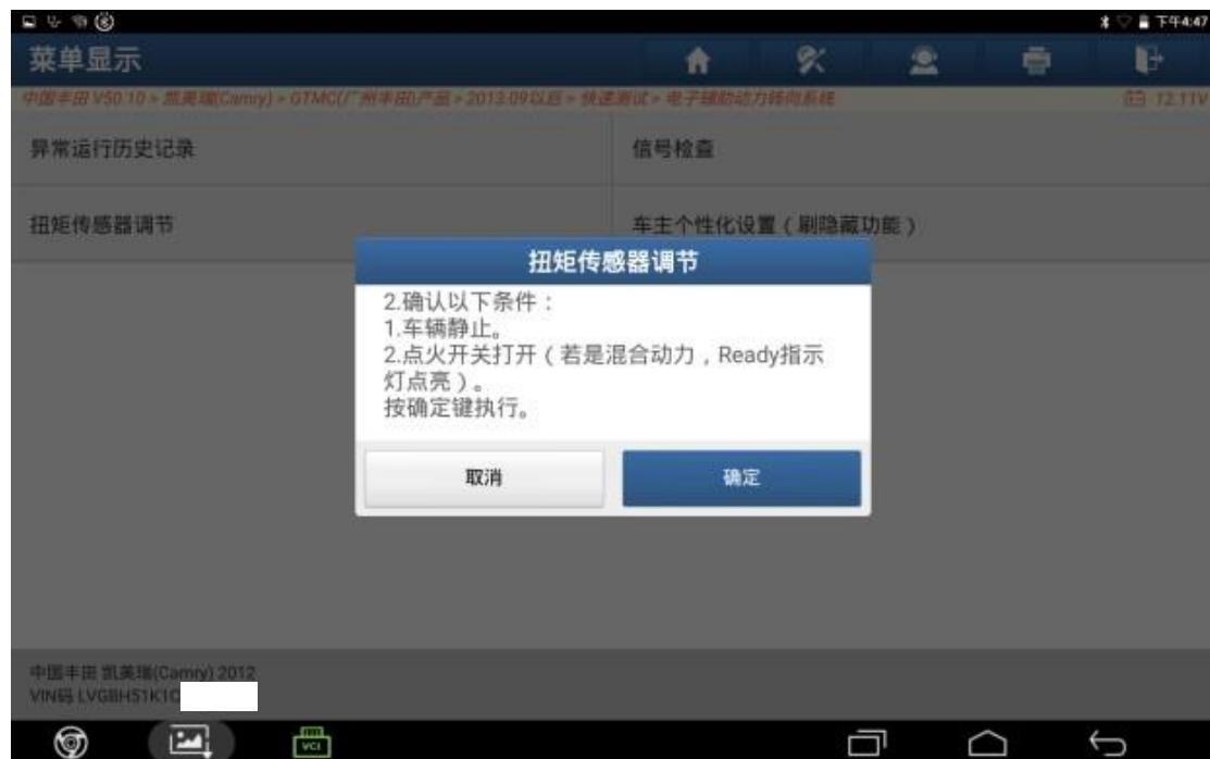
12. 关闭点火开关，再次打开点火开关，点击“确定”；
