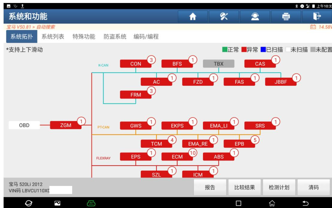
5. 查看系统显示的故障码，所有系统都带有“运输模式已激活”故障（如下图）：
