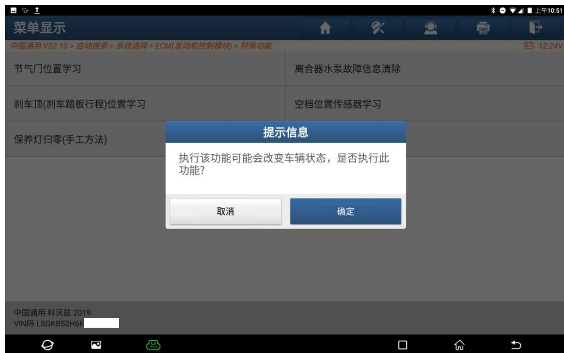
7. 提示“发动机起动、车辆怠速、档位在空挡、拉手刹”，然后点“确定”开始学习(如下图);
