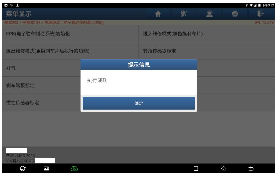
8. 更换刹车片后, 选择【退出维修模式(更换刹车片后执行的功能)】(如下图);
