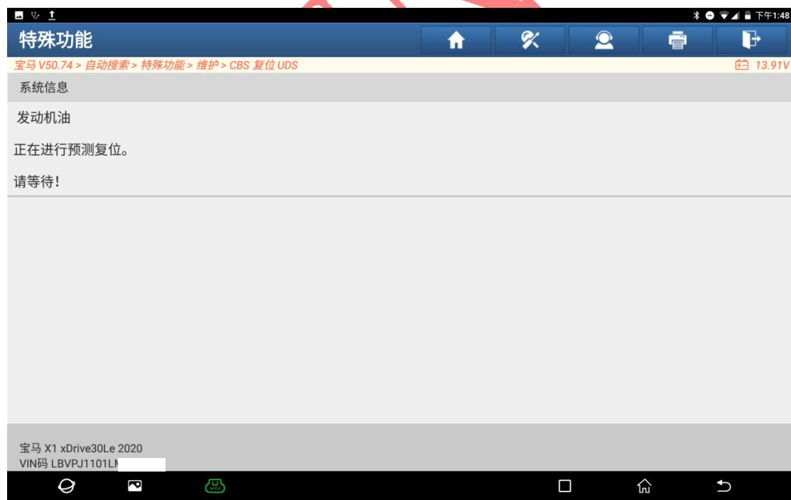
10. 执行复位后，机油显示“100%/12000km/3”，点“F11”退出（如下图）；
